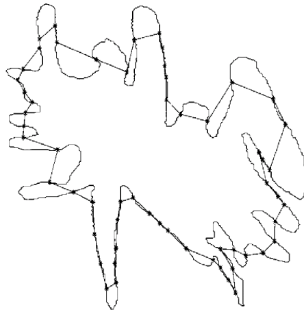
Figura 2.2: Pontos de inflexão detectados pelo método proposto por Rangayyan [2]
