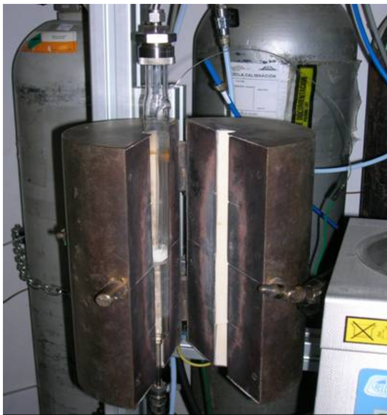
Figura 42 - Detalhe do leito do reator com catalisador e aditivo e poço do termopar
