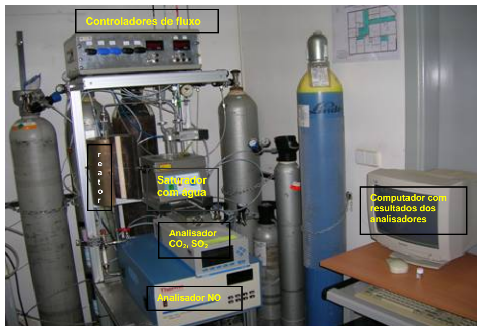
Figura 41 – Foto da unidade de teste catalítico
