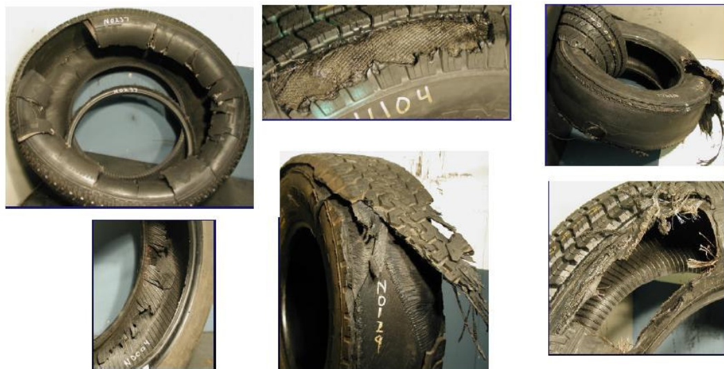
Fig. 2.3: Exemplos de pneus em colapso estrutural após sofrerem descolamento da banda de rodagem.
