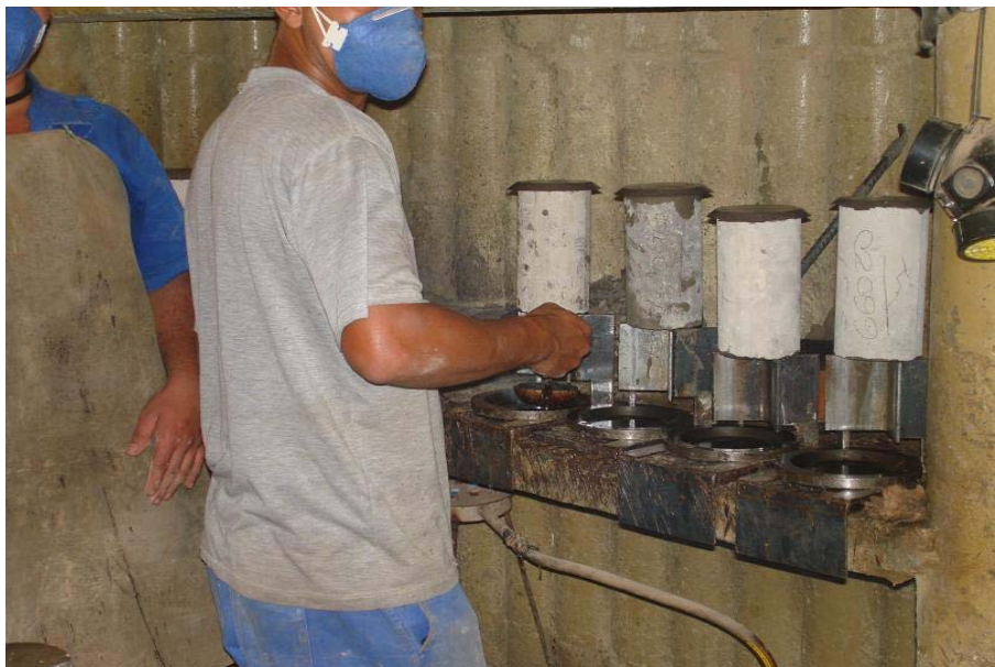
FIGURA 4.7. – Capeamento dos CPs com enxofre.
