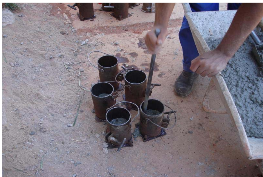
FIGURA 4.4. - Moldagem dos corpos de prova.
