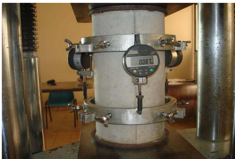
FIGURA 4.11. – Aplicação de carga para o ensaio de módulo.
