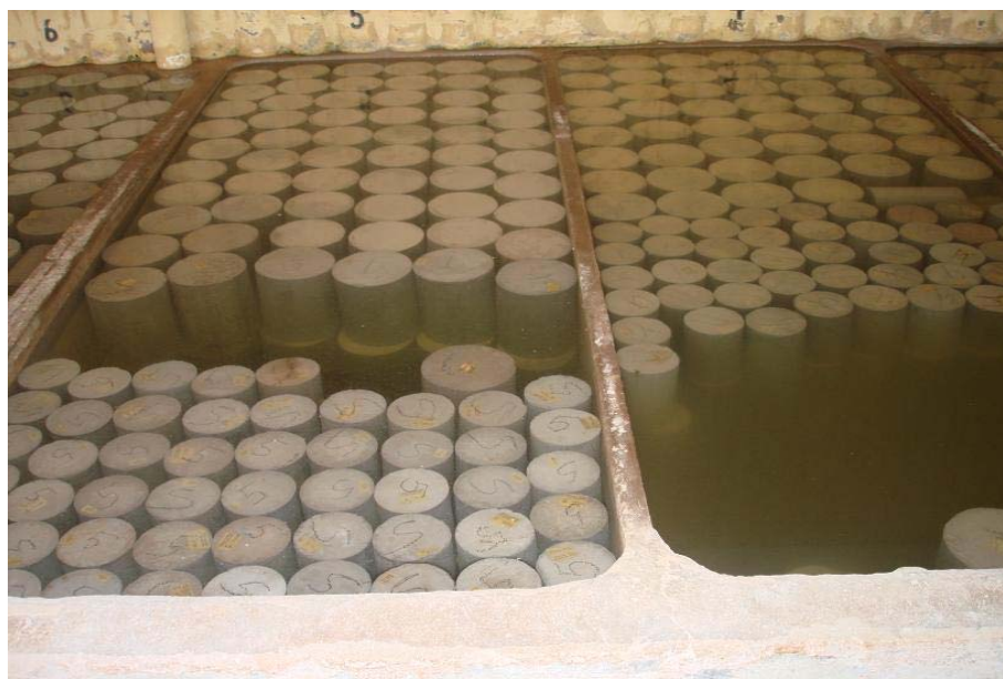
FIGURA 4.6. – CPs imersos em água saturada com cal para cura.
