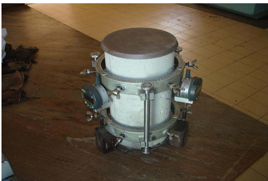
FIGURA 4.9. – Preparação do corpo de prova para o ensaio do módulo de deformação tangente inicial.
