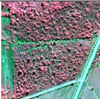
Cerrado típico – IKONOS II (fusionada/PAN) – composição falsa cor RGB 432 – resolução espacial de 1 m.
