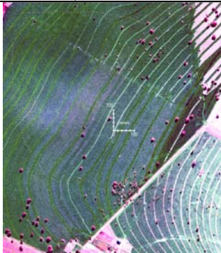
IKONOS II (fusionada/PAN) – composição falsa cor RGB 432 – resolução espacial de 1 m.
