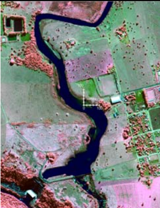
IKONOS II (fusionada/PAN) – composição falsa cor RGB 432 – resolução espacial de 1 m.
