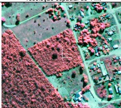
Cerrado denso – IKONOS II (fusionada/PAN) – composição falsa cor RGB 432 – resolução espacial de 1 m.
