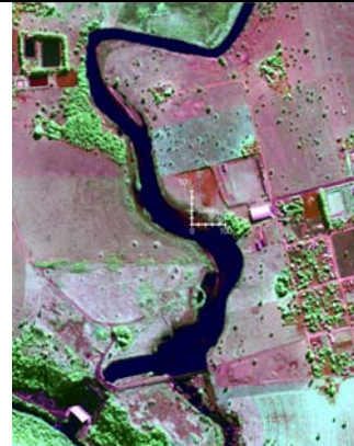
IKONOS II (fusionada/PAN) – composição falsa cor RGB 342 – resolução espacial de 1 m.
