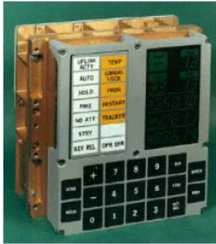
Figura 3.1: Exemplo de Sistema Embarcado: Sistema de Navegação da Espaçonave Apollo da NASA
