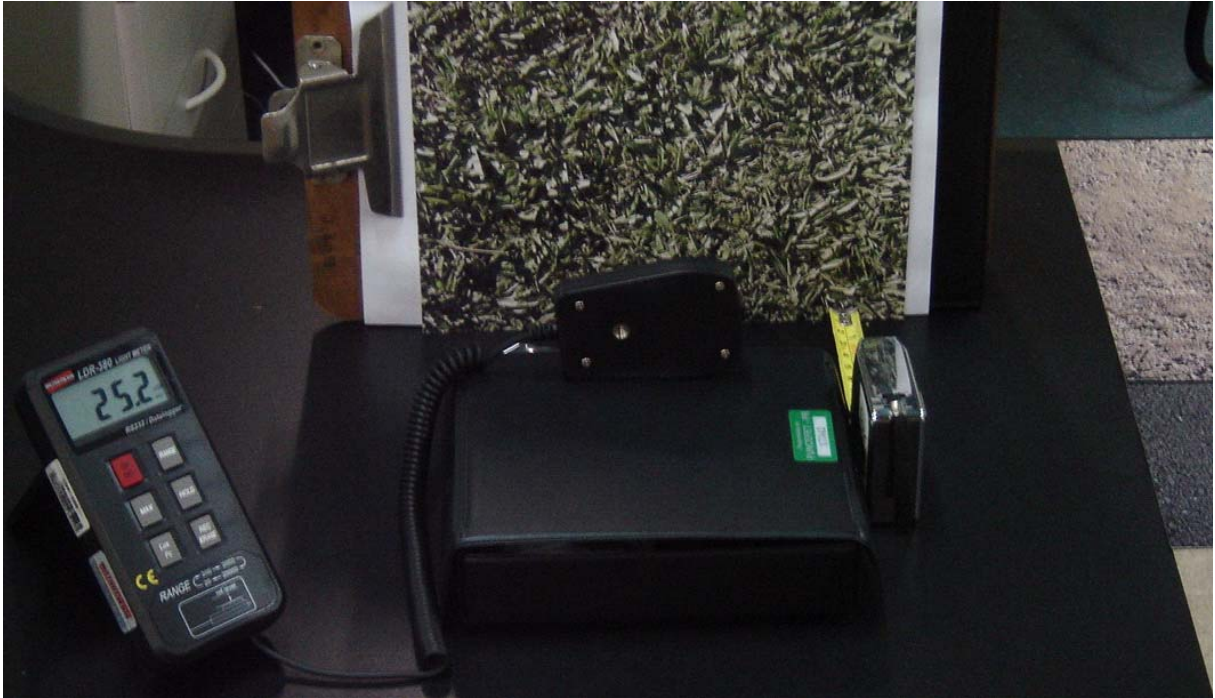
FOTO 46 – MEDIÇÃO DA EMISSIVIDADE DOS PISOS REPRODUZIDOS EM FOTOGRAFIA. FONTE: Autoria própria (2007)
