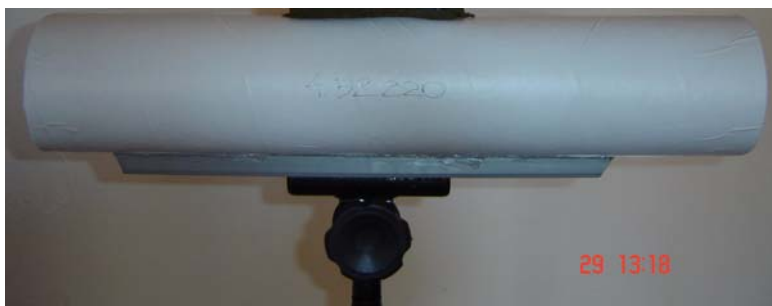
FOTOS 13 E 14 – TERMÔMETRO PROTEGIDO DENTRO DE TUBO. FONTE: Autoria própria (2007)
