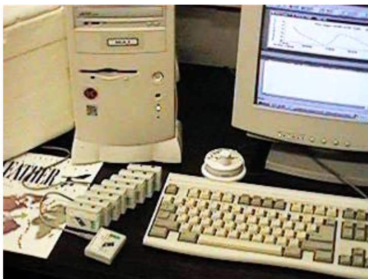
FOTO 18 – AFERIÇÃO ENTRE OS APARELHOS HOBO FONTE: Aatoria própria (2007)
