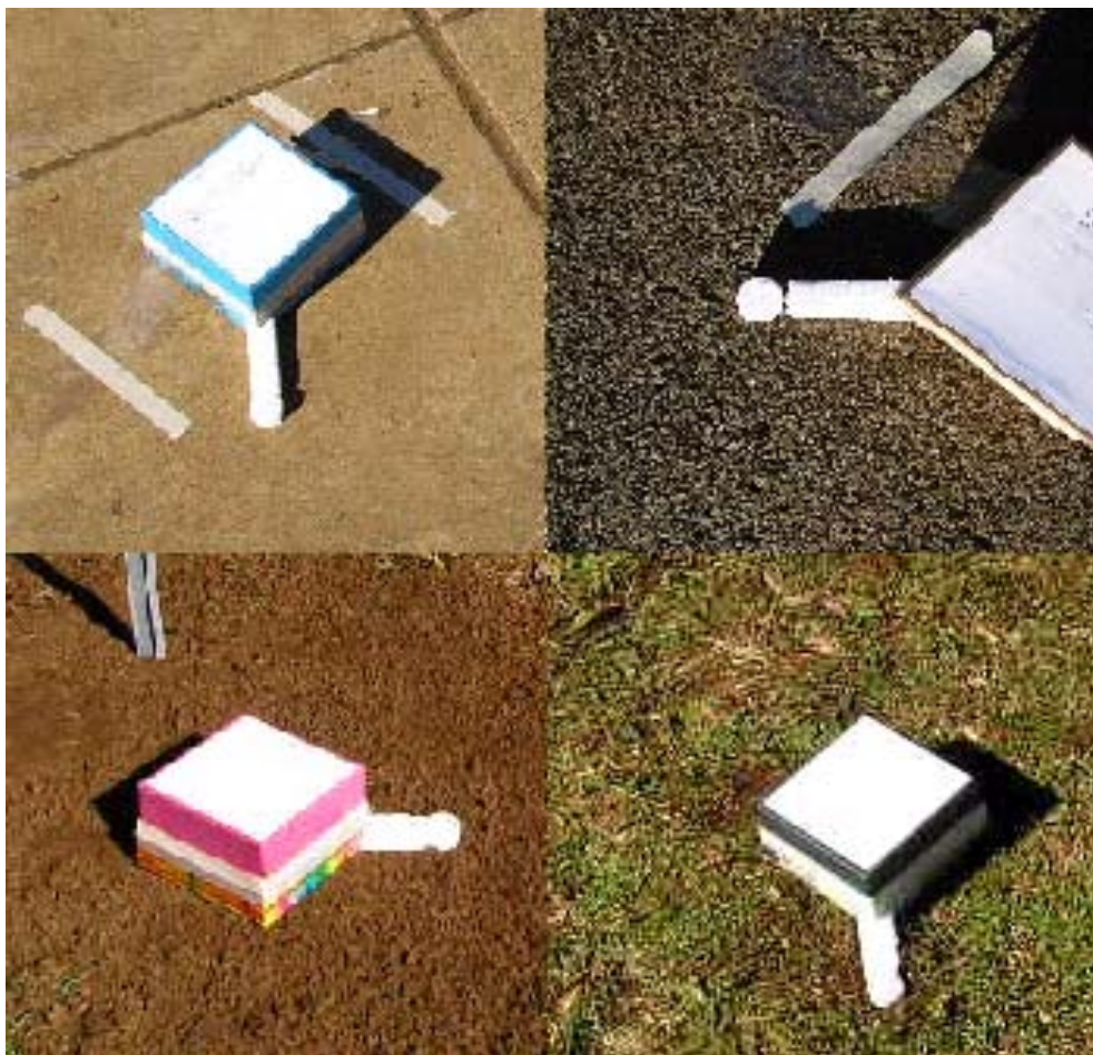
FOTO 43 – MEDIÇÃO DA TEMPERATURA SUPERFICIAL DO SOLO - TERMÔMETROS HOBO. A PARTIR DA ESQUERDA PARA A DIREITA, DE CIMA PARA BAIXO, PISOS DE CONCRETO, ASFALTO, TERRA E GRAMA. FONTE: Autoria própria (2007)
