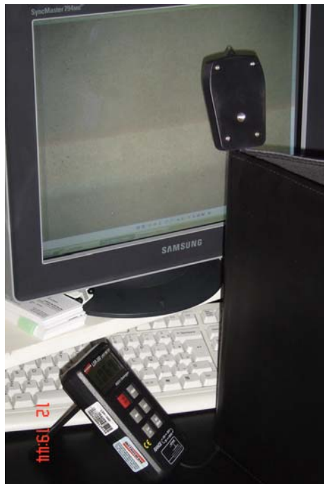
FOTO 47 – MEDIÇÃO DA EMISSIVIDADE DOS PISOS REPRODUZIDOS EM MONITOR. FONTE: Autoria própria (2007)
