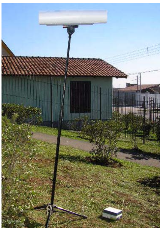
FOTO 15 – TRIPÉ COM TERMÔMETRO AUTOMÁTICO PARA TEMPERATURA AMBIENTE. FONTE: Autoria própria (2007)
