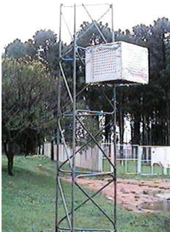
FOTO 08- SENSOR INSTALADO DENTRO DE CAIXA PROTETORA FONTE: Aatoria própria (2004)
