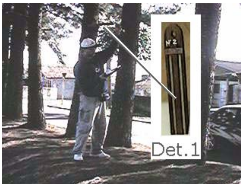
FOTO 11 – EQUIPAMENTOS PARA TRANSECTO: NO DETALHE 1, PSICRÔMETRO DE FUNDA. FONTE: Autoria própria (2004)
