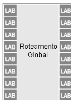
Figura 2.2. Arquitetura tradicional de um CPLD (ALTERA, 2007a)
