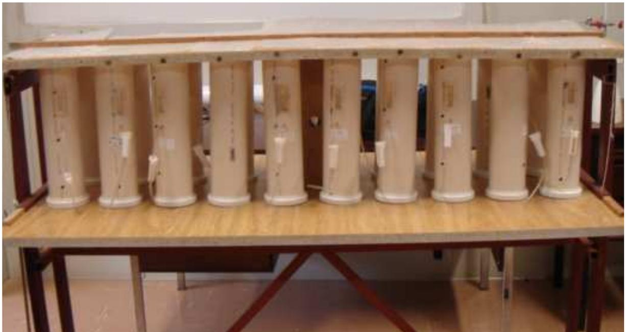
Figura 5.1 – Mesa adaptada com tubos de PVC utilizados no fracionamento físico das amostras de solo.
