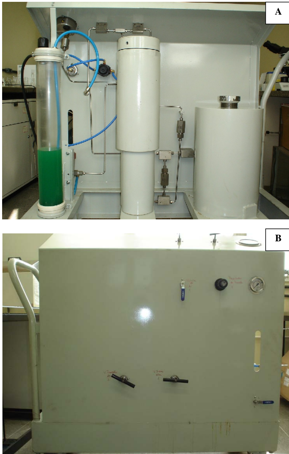
Figura 1. Sistema de alta pressão hidrostática. (A) visão frontal (B) visão posterior
