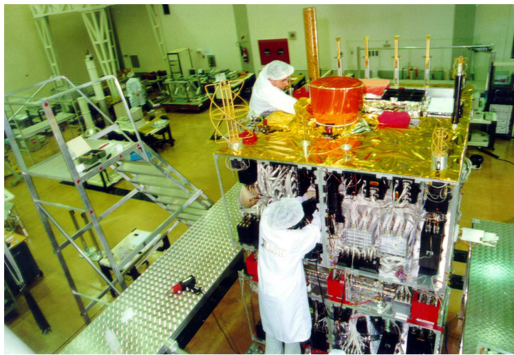
Figura 2-1. LIT-INPE – Montagem Final CBERS 2.
