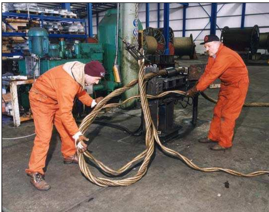
Figura 19 – Resultado de um Riser em que ocorreu o Looping .
