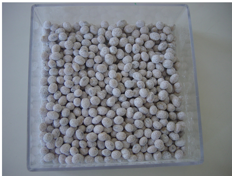
Figura 3: Visual das sementes aderidas à Fitina e/ou Fosfato Bicálcico, antes de recobertas com o polímero.
