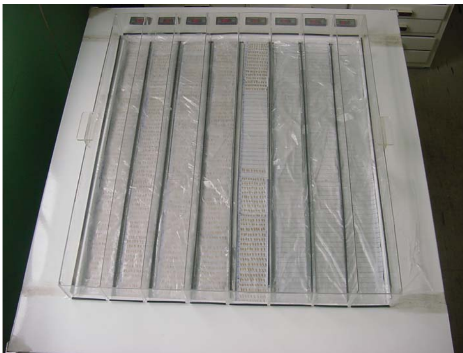
FIGURA 2 – Vista superior da mesa termogradiante, com a tampa de cobertura, no dia da semeadura, mostrando as régua 5, 6, 7 e 8 semeadas e a régua 4 em semeadura parcial (da esquerda para direita: régua 8, 7, 6, 5, 4, 3, 2 e 1).
