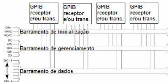
Figura 52 - Topologia em barra com GP-IB
