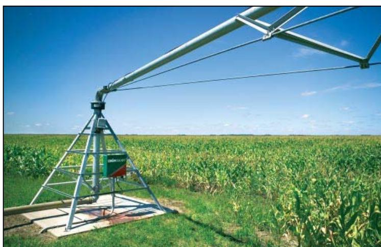
Figura 4.23 - Extremidade inicial de um pivô central. Ponto fixo.
