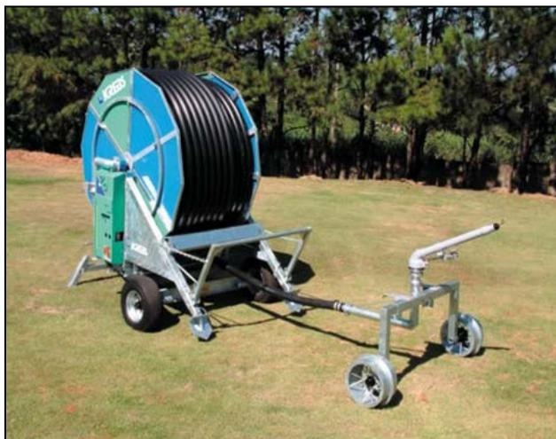
Figura 4.20 - Autopropelido tracionado pela mangueira (Krebsfer).
