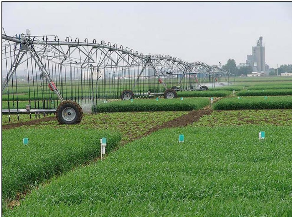
Figura 4.39 - Sistema de deslocamento linear, com aplicação localizada (J. Kim).
