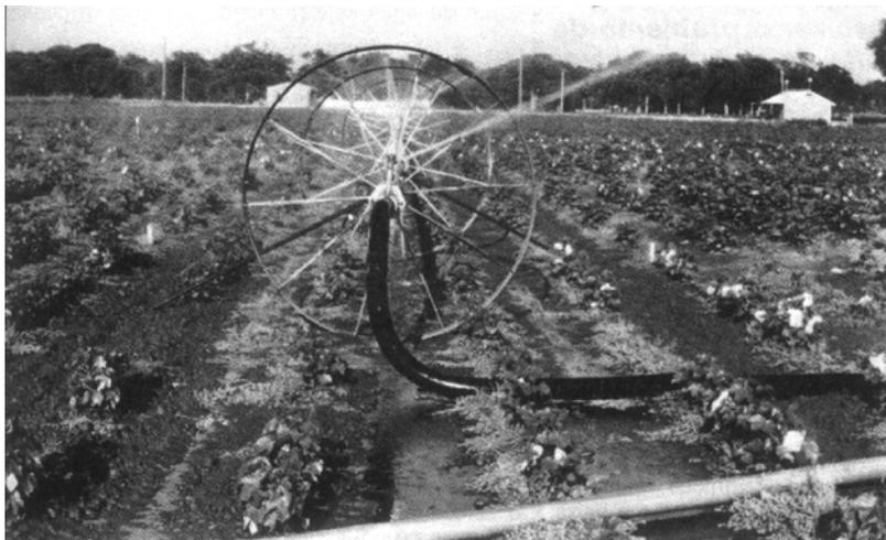
Figura 4.15 - Sistema tipo lateral rolante (DAEE-SP).
