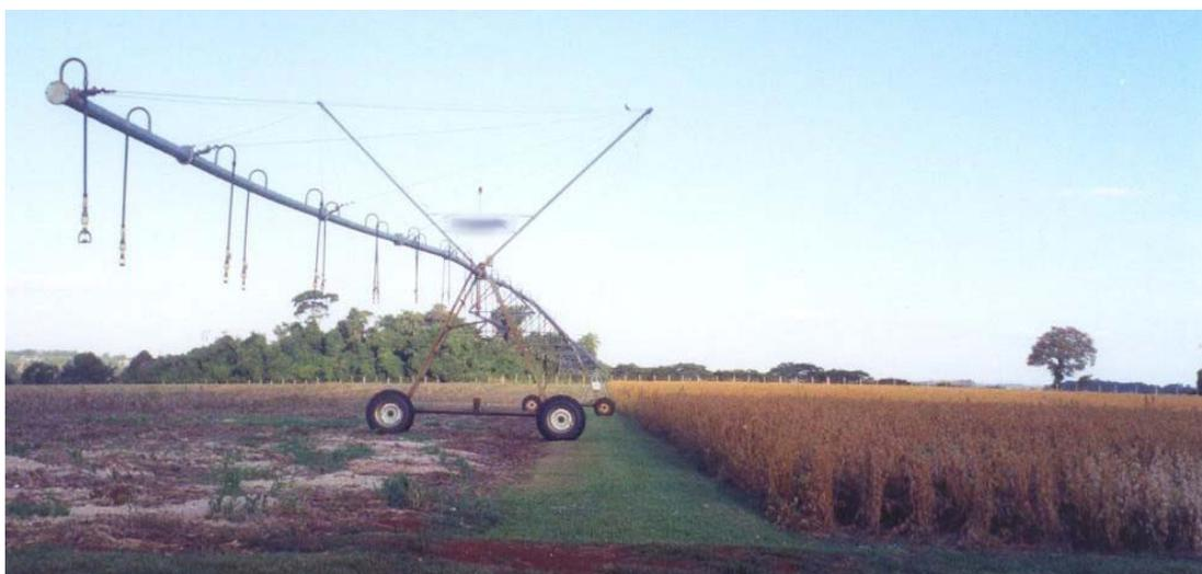
Figura 4.25 - Lance em balanço em linha de pivô central setorial.
