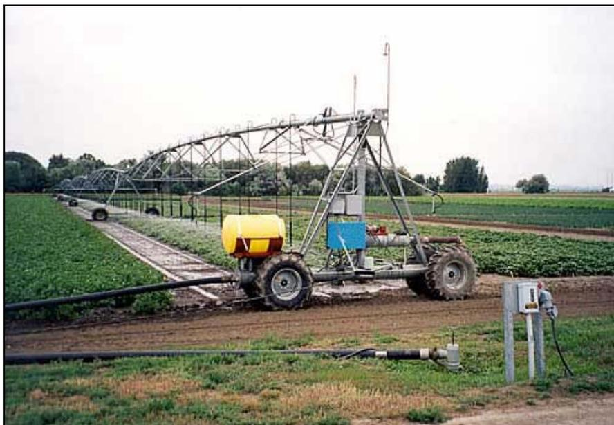
Figura 4.36 - Sistema de deslocamento linear (SCHERER, T., 2005).
