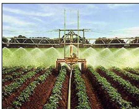
Figura 4.21 - Autopropelido tracionado pela mangueira, com barra irrigadora.
