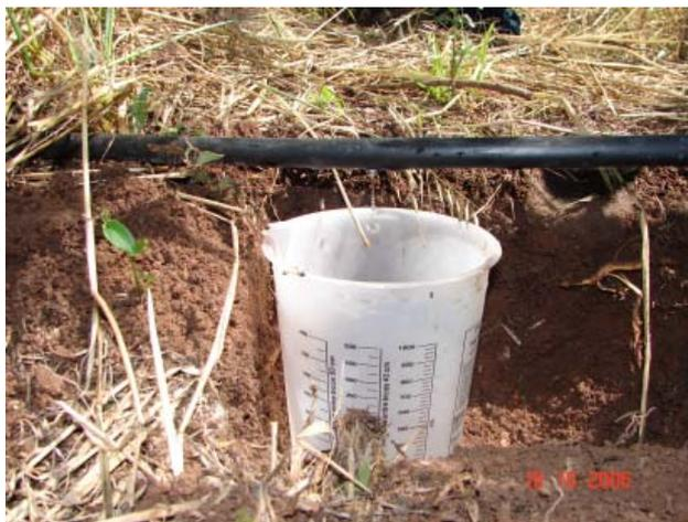
Figura 3.8 – Teste de vazão em gotejador.
