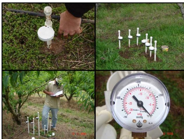
Figura 3.7 – Instalação de tensiômetros e monitoramento da tensão da água no solo.
