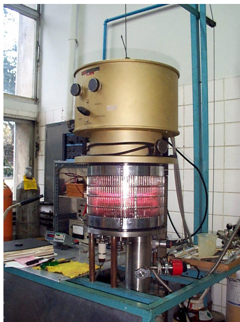
Fig. 3.2. Fotografia do sistema utilizado para deposição dos filmes. Laboratório de Superfícies e Filmes Finos do PEMM / COPPE/UFRJ/Rio de Janeiro [68].
