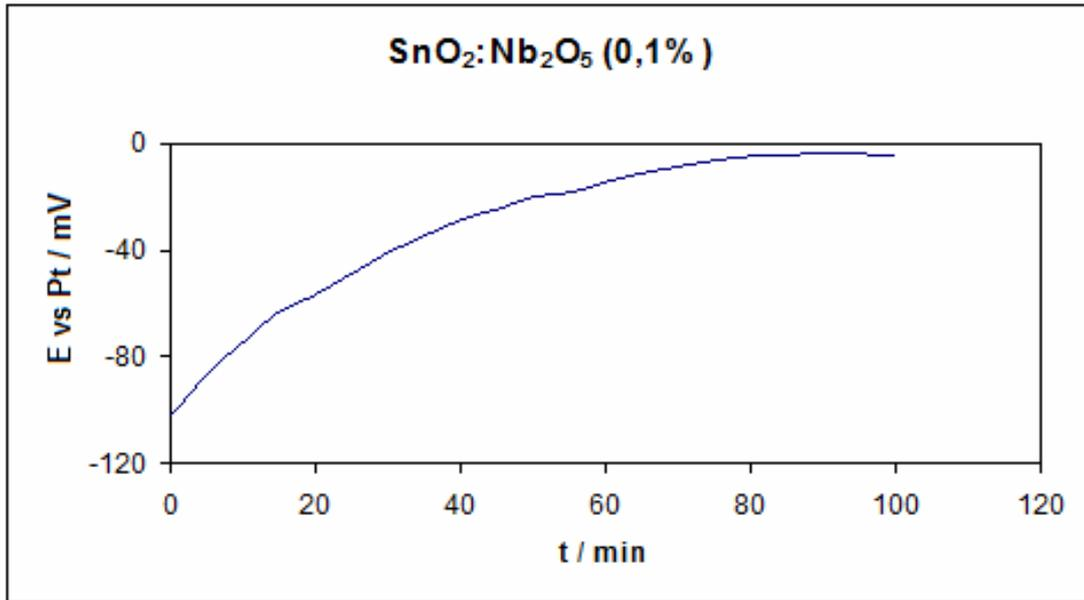
**Figura 4.49:** Estabilização de Eca para amostra de  $\text{SnO}_2:\text{Nb}_2\text{O}_5$  (0,1%).
