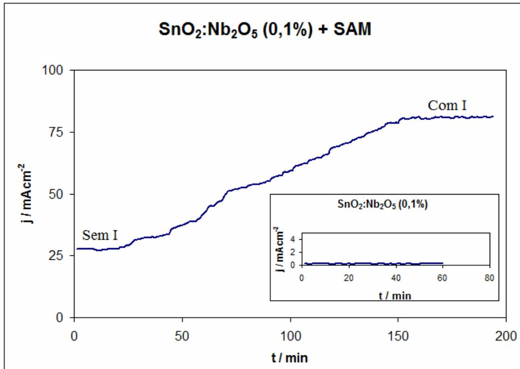
**Figura 4.57:** Fotocronoamperograma de amostra de filme de  $\text{SnO}_2:\text{Nb}_2\text{O}_5$  (0,1%) com tratamento com SAM (quadro maior) e sem o tratamento (quadro menor) com e sem iluminação (I).
