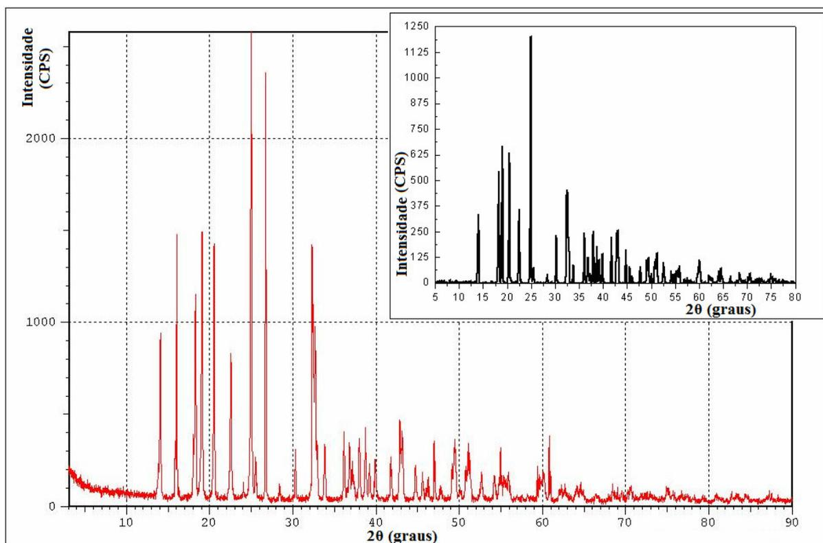
**Figura 4.2:** comparação entre difratogramas de raios X de amostras de tartarato de estanho. Amostra em estudo (vermelho), amostra retirada de referência<sup>(30)</sup> (em preto).
