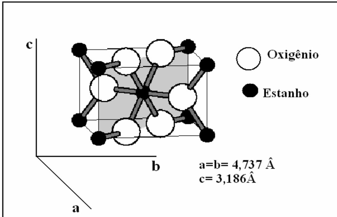
**Figura 2.10:** Cella unitária tetragonal de  $\text{SnO}_2$  com estrutura rutila com a indicação dos parâmetros de rede (a, b e c) e os planos (110) em destaque na cor cinza. Adaptado da referência 29.
