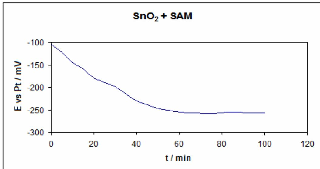
**Figura 4.48:** Estabilização de Eca para amostra de SnO<sub>2</sub> puro com SAM após a deposição do filme.
