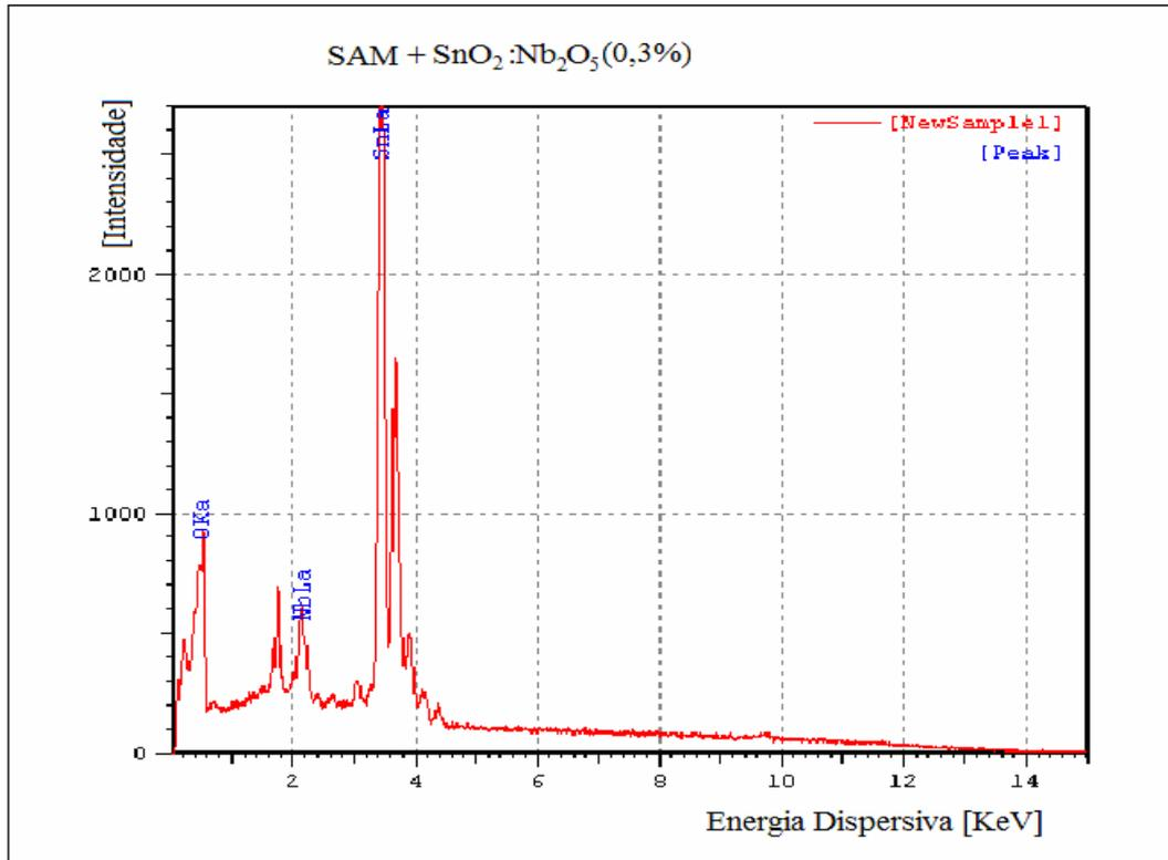
Figura 4.35: EDS de amostra de filme de SnO<sub>2</sub>: Nb<sub>2</sub>O<sub>5</sub> (0,3%) com tratamento de SAM antes de sua deposição.
