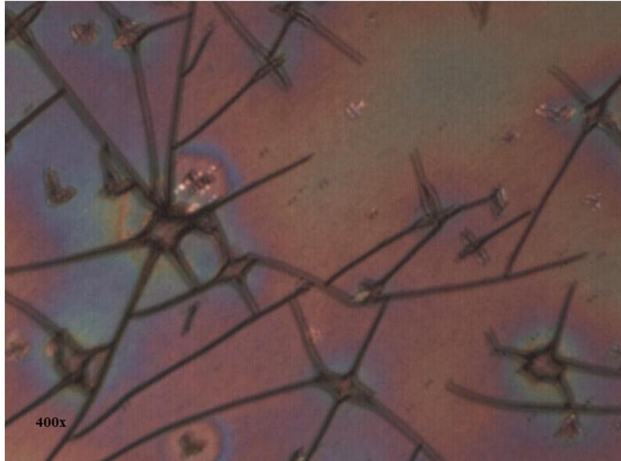
**Figura 4.38:** Micrografia óptica de amostra de filme de SnO<sub>2</sub>: Nb<sub>2</sub>O<sub>5</sub> (0,1%). Ampliação de 400x.
