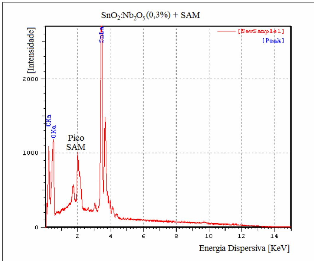
Figura 4.36: EDS de amostra de filme de SnO<sub>2</sub>: Nb<sub>2</sub>O<sub>5</sub> (0,3%) com tratamento de SAM após sua deposição.
