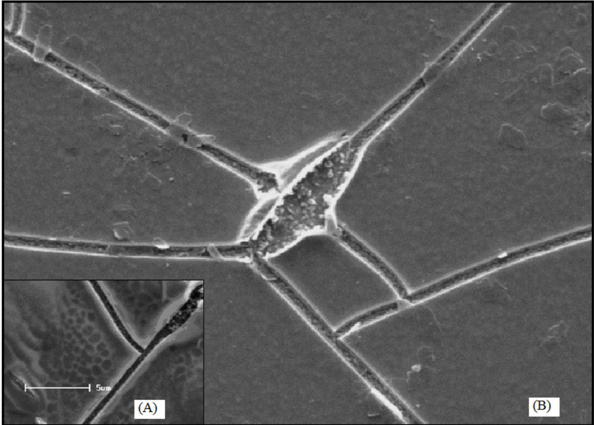
**Figura 4.27:** Micrografia gerada por MEV de filme de SnO<sub>2</sub> puro: (A) sem SAM; (B) com SAM.
