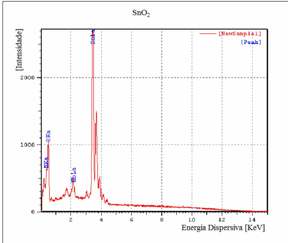
Figura 4.18: EDS de amostra de filme de SnO<sub>2</sub> puro.
