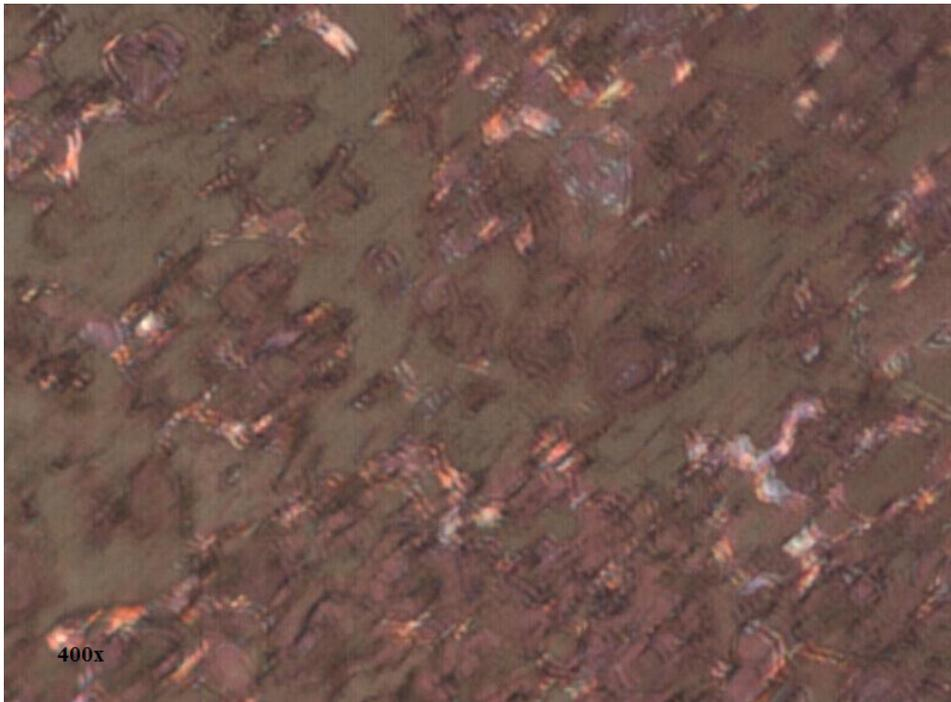
**Figura 4.41:** Micrografia óptica de amostra de filme de SnO<sub>2</sub> puro com SAM após deposição de filme.
