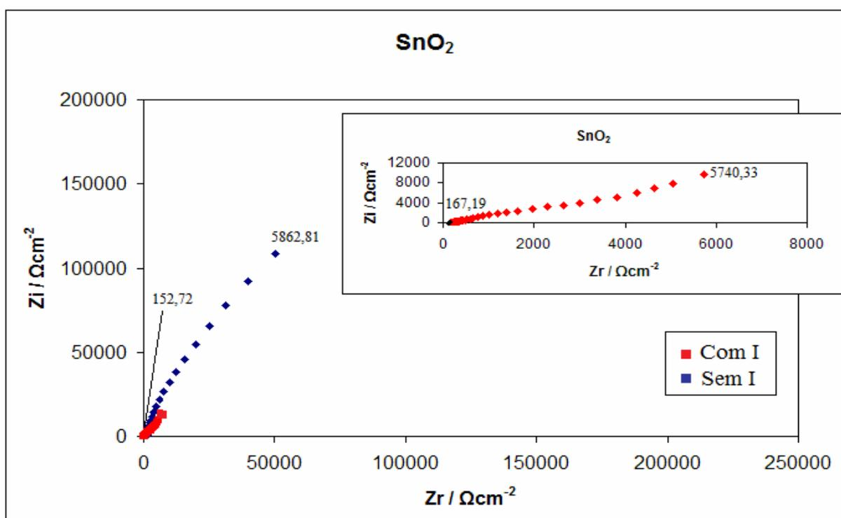
**Figura 4.61:** Diagramas de EIE de amostra de filme de SnO<sub>2</sub> com e sem iluminação (I).
