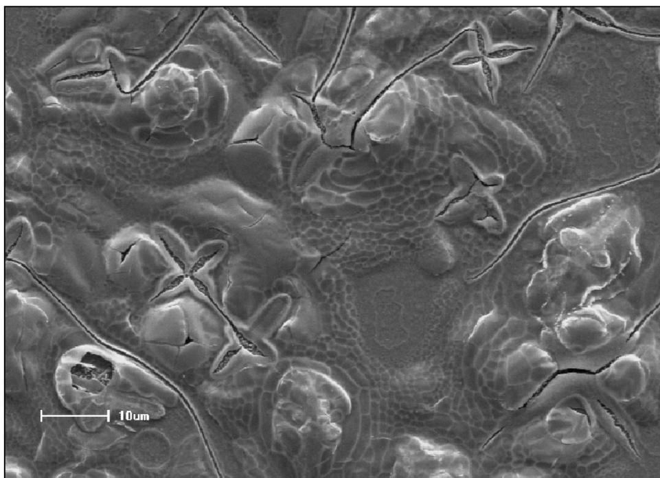
**Figura 4.15:** Micrografia gerada por MEV de amostra de filme de SnO<sub>2</sub> puro.
