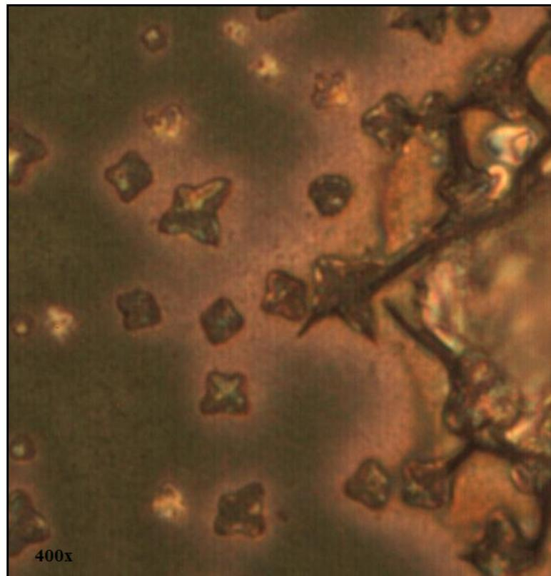
**Figura 4.10:** Micrografia óptica de amostra de filme de SnO<sub>2</sub> puro (borda do eletrodo), ampliação de 400x.
