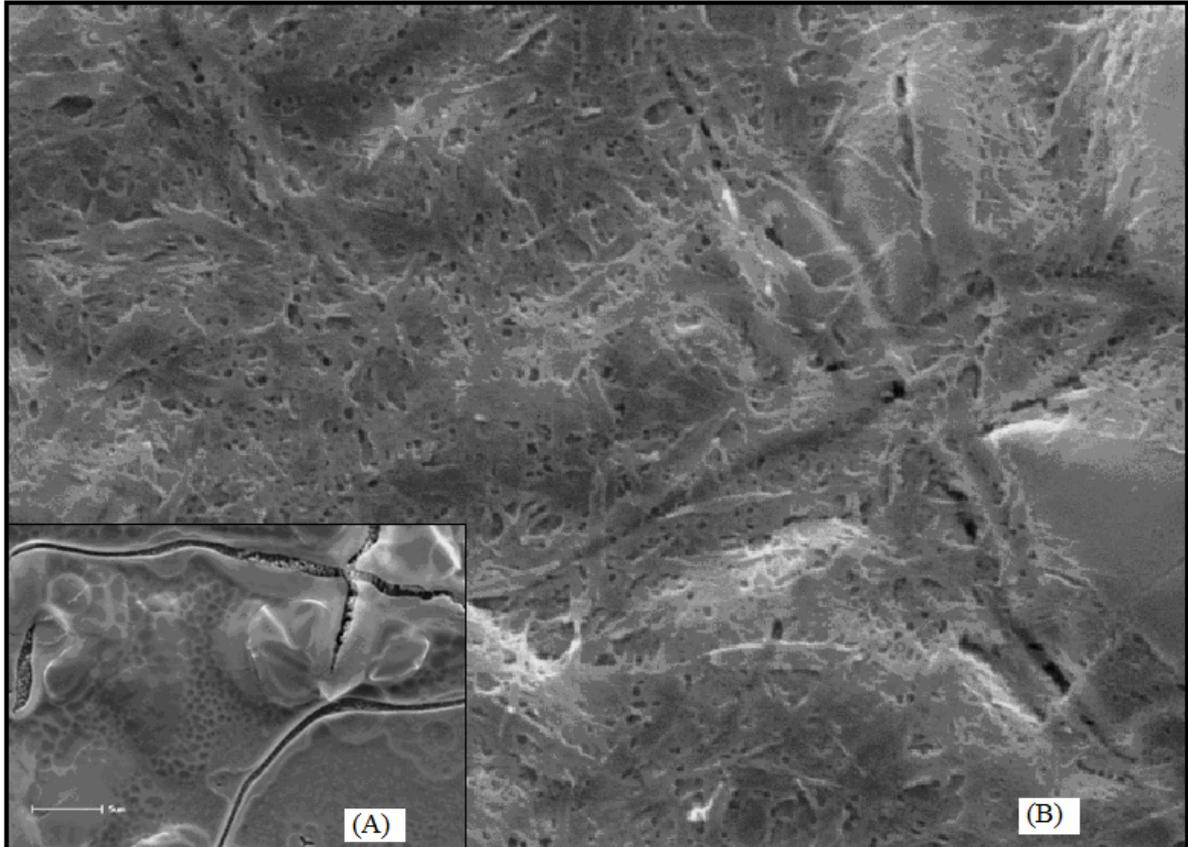
**Figura 4.28:** Micrografia gerada por MEV de filme de SnO<sub>2</sub>:Nb<sub>2</sub>O<sub>5</sub> (0,1%): (A) sem SAM; (B) com SAM.
