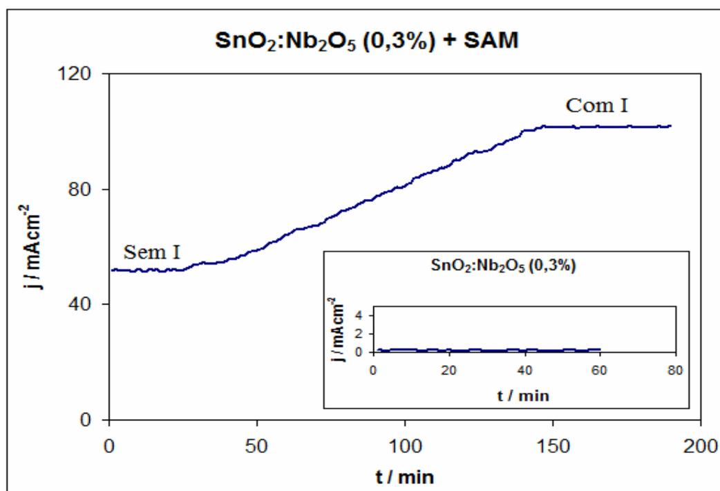
**Figura 4.59:** Fotocronoamperograma de amostra de filme de  $\text{SnO}_2:\text{Nb}_2\text{O}_5$  (0,3%) com tratamento com SAM (quadro maior) e sem o tratamento (quadro menor) com e sem iluminação (I).
