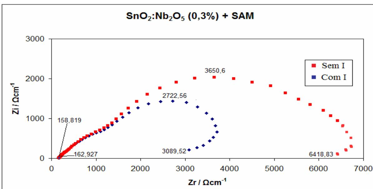
Figura 4.66: Diagramas de EIE de amostra de filme de  $\text{SnO}_2:\text{Nb}_2\text{O}_5$  (0,3%) com tratamento com SAM com e sem iluminação (I).
