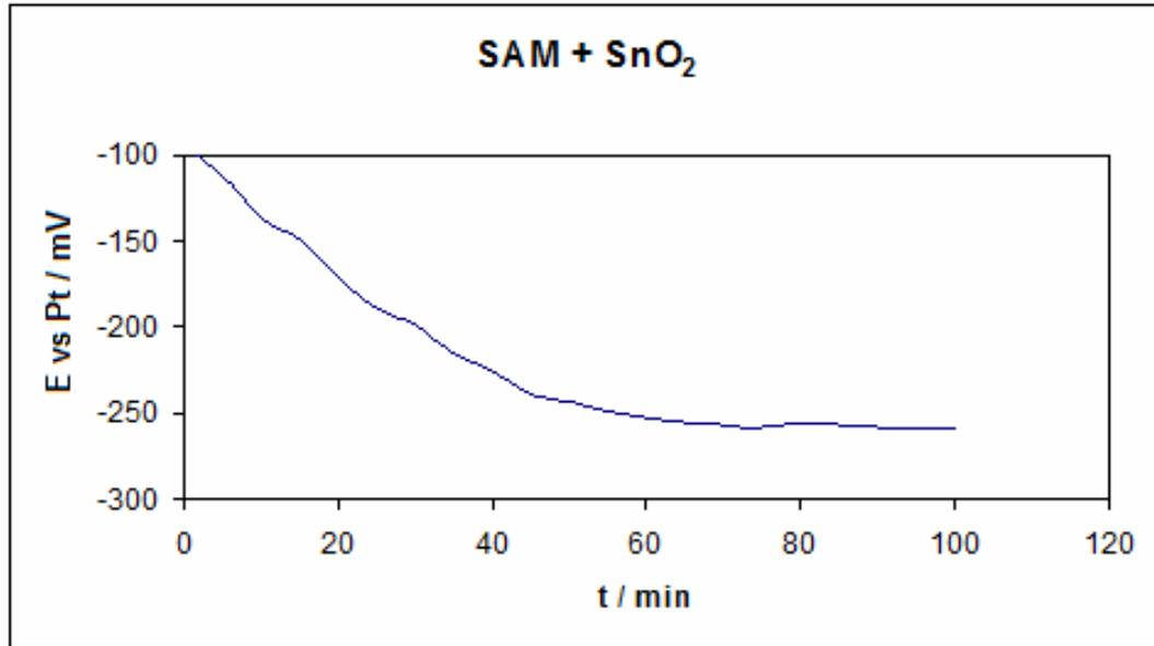
**Figura 4.47:** Estabilização de Eca para amostra de SnO<sub>2</sub> puro com SAM antes da deposição do filme.
