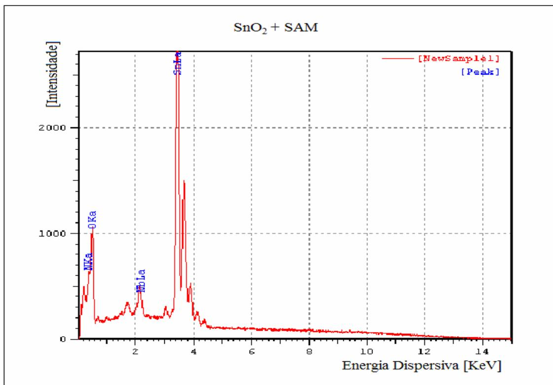
Figura 4.32: EDS de amostra de filme de SnO<sub>2</sub> puro com tratamento de SAM após sua deposição.
