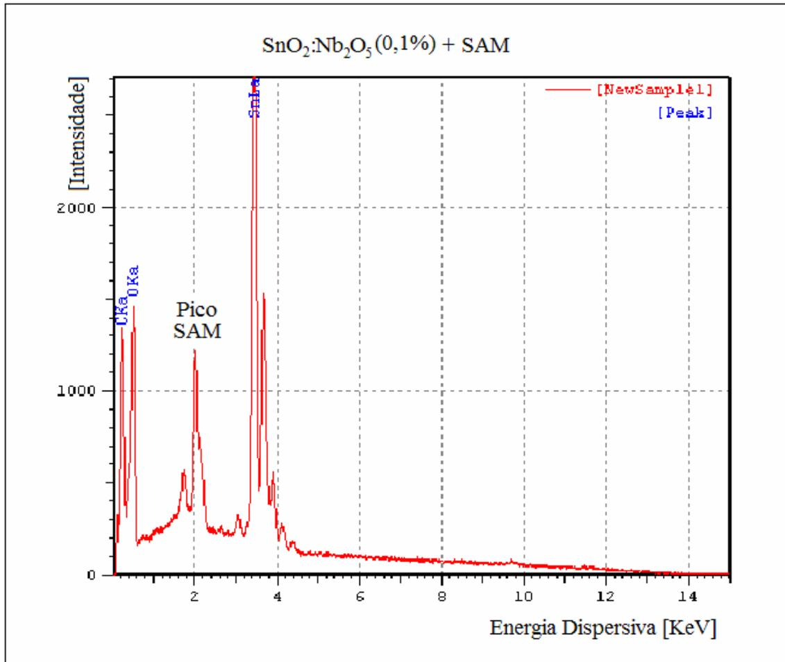
**Figura 4.34:** EDS de amostra de filme de SnO<sub>2</sub>: Nb<sub>2</sub>O<sub>5</sub> (0,1%) com tratamento de SAM.
