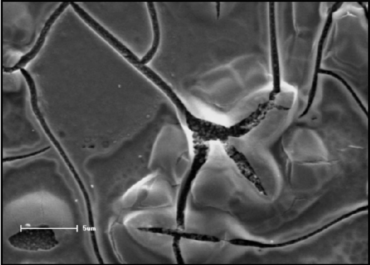
**Figura 4.26:** Micrografia gerada por MEV com agregação de SAM antes da deposição de filme de  $\text{SnO}_2:\text{Nb}_2\text{O}_5$  (0,3%).
