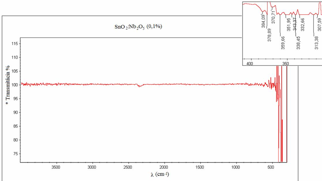
**Figura 4.22:** Espectro de IV referente à amostra de SnO<sub>2</sub>:Nb<sub>2</sub>O<sub>5</sub> (0,1%). Quadro menor: destaque para bandas entre 410 e 300 cm<sup>-1</sup>.
