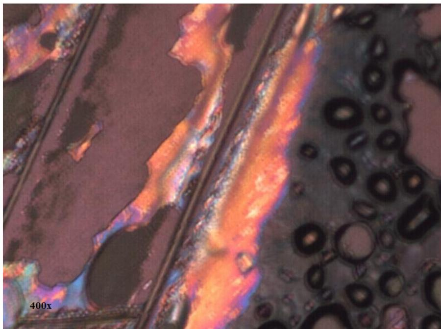
**Figura 4.39:** Micrografia óptica de amostra de filme de SnO<sub>2</sub>: Nb<sub>2</sub>O<sub>5</sub> (0,3%). Ampliação de 400x.
