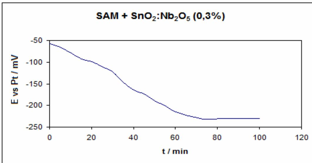
**Figura 4.53:** Estabilização de Eca para amostra de SnO<sub>2</sub>:Nb<sub>2</sub>O<sub>5</sub> (0,3%) com SAM antes da deposição do filme.
