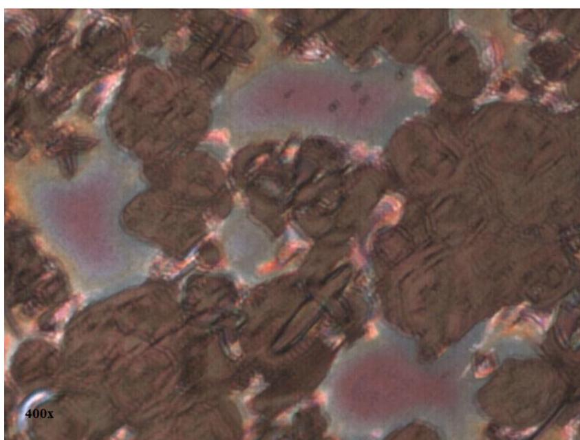
**Figura 4.37:** Micrografia óptica de amostra de filme de SnO<sub>2</sub> puro. Ampliação de 400x.
