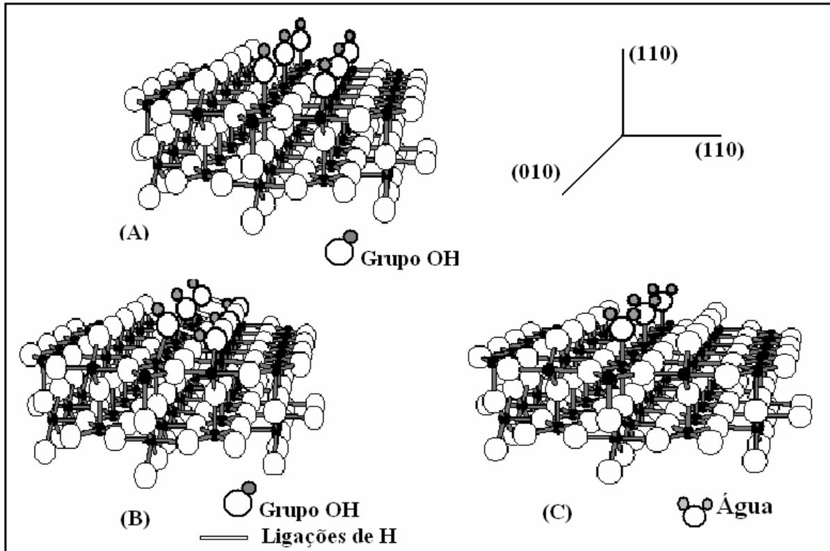
**Figura 2.12:** Superfície de SnO<sub>2</sub> (110) com algumas espécies adsorvidas. Em (A) grupos OH; (B) grupos OH e ligações de Hidrogênio; (C) moléculas de água. Adaptado da referência 29.
