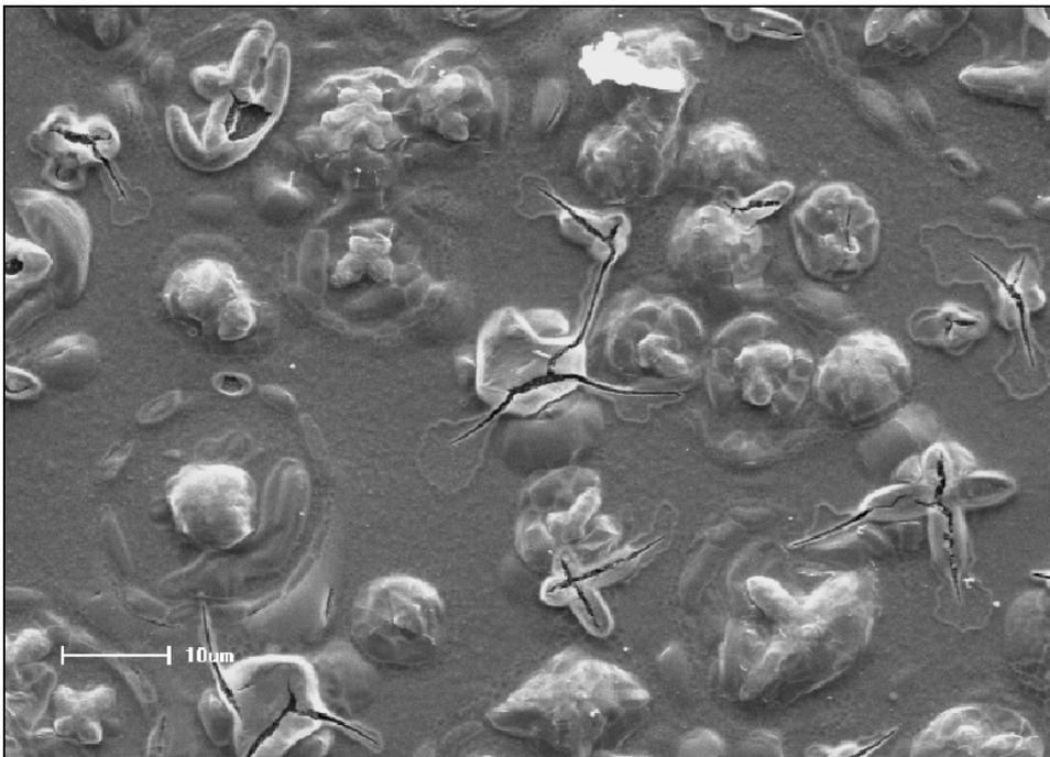
**Figura 4.17:** Micrografia gerada por MEV de amostra de filme de SnO<sub>2</sub>: Nb<sub>2</sub>O<sub>5</sub> (0,3%).
