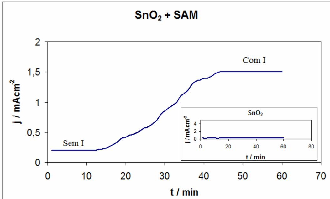
**Figura 4.55:** Fotocronoamperograma de amostra de filme de SnO<sub>2</sub> com tratamento com SAM (quadro maior) e sem o tratamento (quadro menor) com e sem iluminação ( $I$ ).
