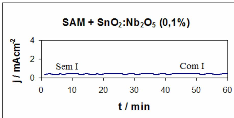
**Figura 4.58:** Fotocronoamperograma de amostra de filme de  $\text{SnO}_2:\text{Nb}_2\text{O}_5$  (0,1%) com SAM antes da deposição do filme com e sem iluminação (I).
