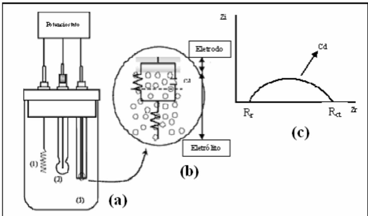
**Figura 3.9:** (a) Célula eletroquímica típica de três eletrodos para uso em EIE: (1) eletrodo auxiliar, (2) eletrodo de referência, (3) eletrodo de trabalho. (b) diagrama esquemático de um circuito Randles superimposto à interferência eletrodo/eletrólito. (c) diagrama de EIE do circuito (b). Adaptado da referência 97.
