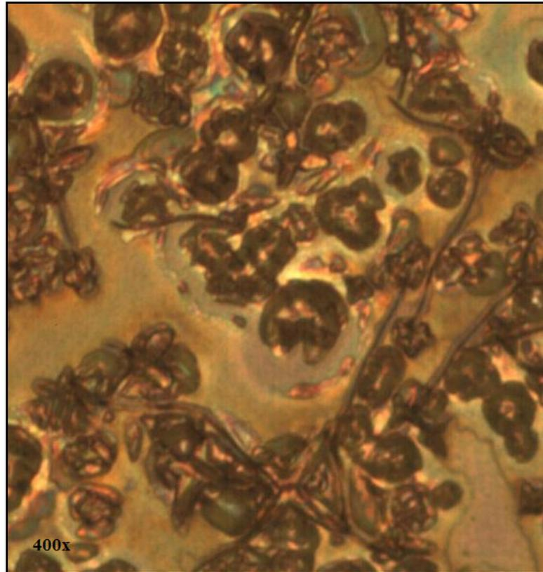
**Figura 4.9:** Micrografia óptica de amostra de filme de SnO<sub>2</sub> puro (centro do eletrodo), ampliação de 400x.
