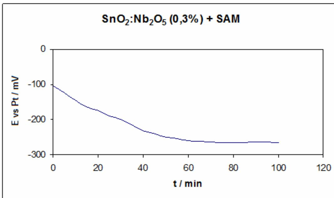
**Figura 4.54:** Estabilização de Eca para amostra de SnO<sub>2</sub>:Nb<sub>2</sub>O<sub>5</sub> (0,3%) com SAM após a deposição.
