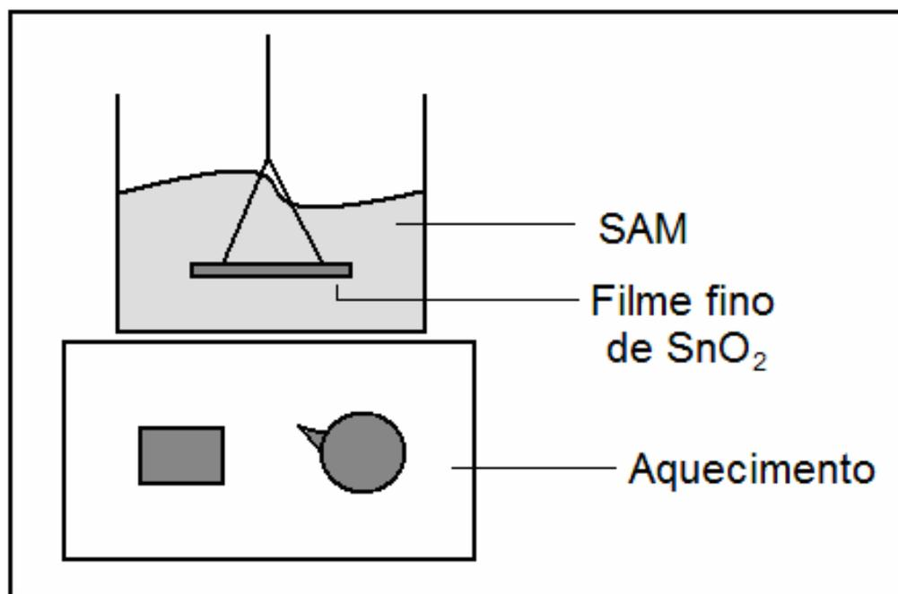
**Figura 3.2:** Representação dos banhos de agregação de SAM na superfície dos filmes finos de SnO<sub>2</sub> dopados ou não.
