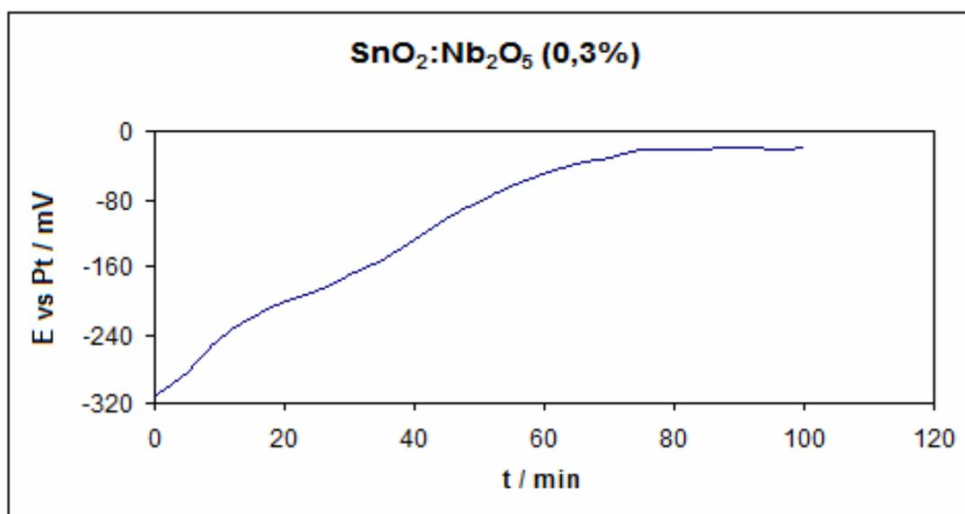
**Figura 4.52:** Estabilização de Eca para amostra de  $\text{SnO}_2:\text{Nb}_2\text{O}_5$  (0,3%).
