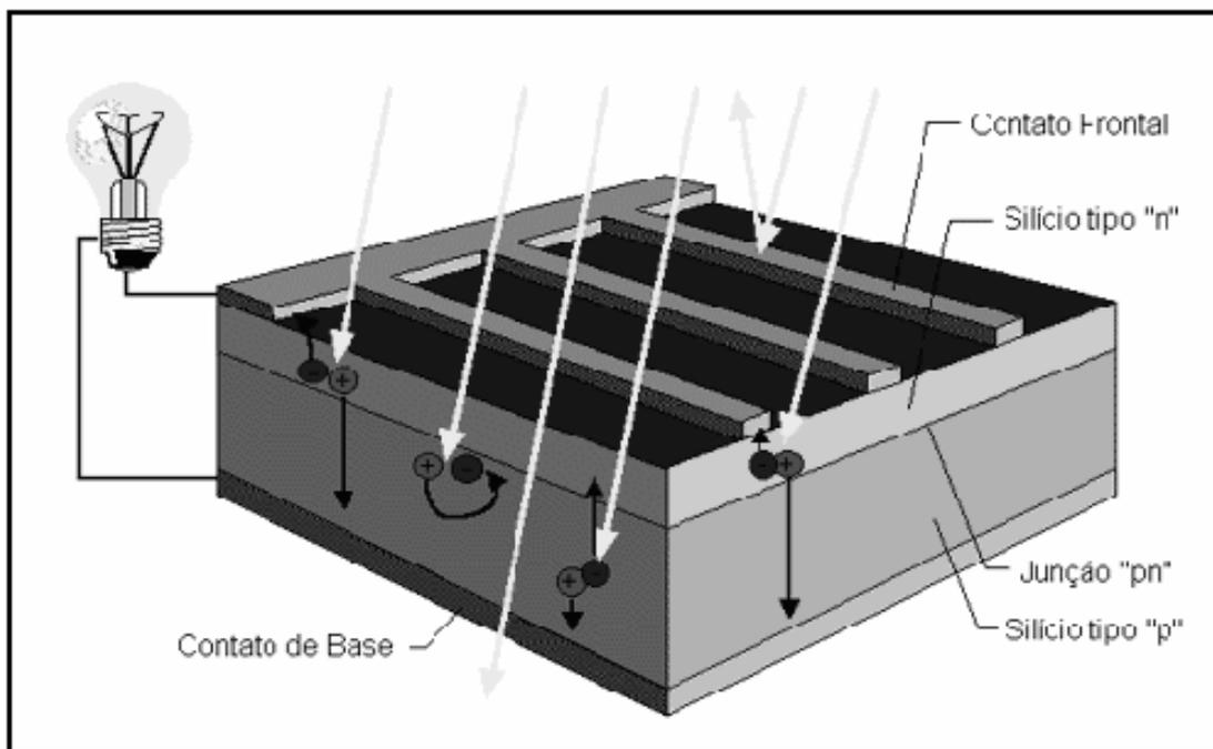
**Figura 2.21:** Corte transversal de uma célula fotovoltaica. Referência 77.
