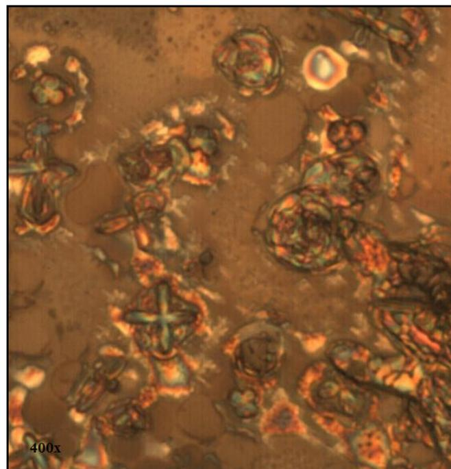
**Figura 4.12:** Micrografia óptica de amostra de filme de SnO<sub>2</sub>: Nb<sub>2</sub>O<sub>5</sub> (0,1%) (borda do eletrodo), ampliação de 400x.
