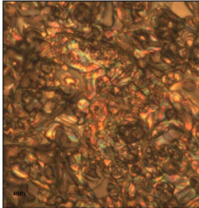
**Figura 4.11:** Micrografia óptica de amostra de filme de SnO<sub>2</sub>: Nb<sub>2</sub>O<sub>5</sub> (0,1%) (centro do eletrodo), ampliação de 400x.
