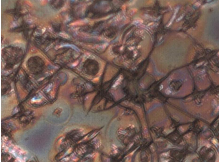
**Figura 4.40:** Micrografia óptica de amostra de filme de SnO<sub>2</sub> puro com SAM antes da deposição do filme.
