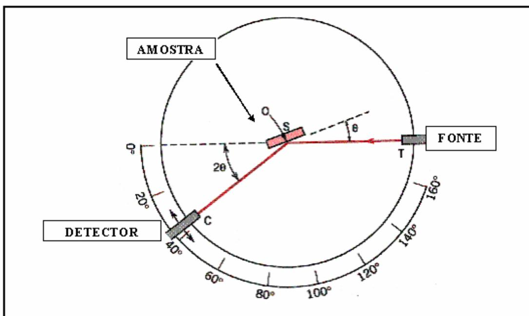
Figura 3.3: Esquema de um difratômetro. Adaptado da referência 87.
