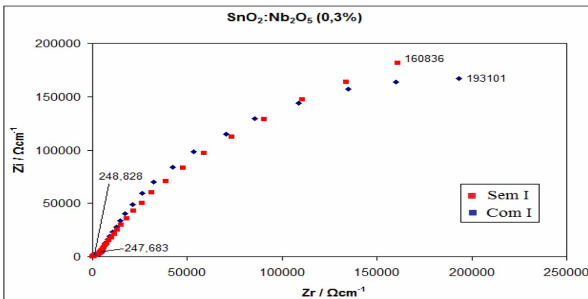
Figura 4.65: Diagramas de EIE de amostra de filme de  $\text{SnO}_2:\text{Nb}_2\text{O}_5$  (0,3%) com e sem iluminação (I).
