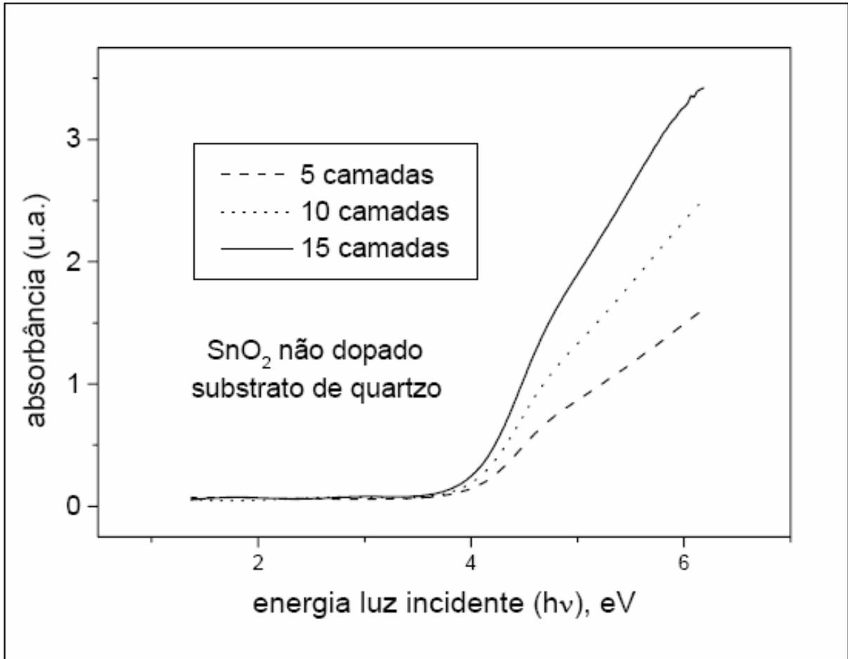
**Figura 2.15:** Absorção óptica no UV-visível de um filme de SnO<sub>2</sub> depositado em substrato de quartzo. Adaptado da referência 67.
