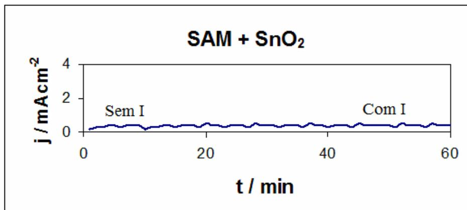
**Figura 4.56:** Fotocronoamperograma de amostra de filme de SnO<sub>2</sub> com SAM antes da deposição do filme com e sem iluminação ( $I$ ).
