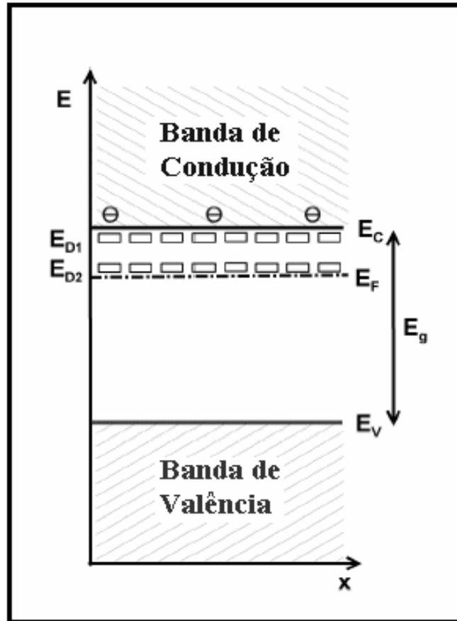
**Figura 2.13:** Diagrama esquemático da banda eletrônica do SnO<sub>2</sub>. Os dois níveis doadores E<sub>D1</sub> (V<sub>O</sub><sup>•</sup>) e E<sub>D2</sub> (V<sub>O</sub><sup>••</sup>) estão localizados a 0,03 e 0,15 eV, respectivamente, abaixo da banda de condução (E<sub>C</sub> = 0 eV). Adaptado da referência 56.
