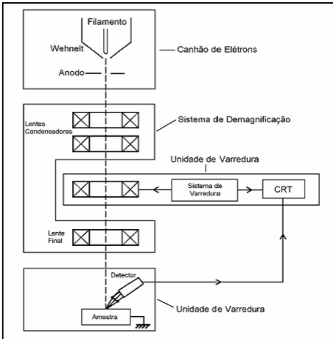
**Figura 3.4:** Representação esquemática dos componentes do Microscópio Eletrônico de Varredura (MEV).
