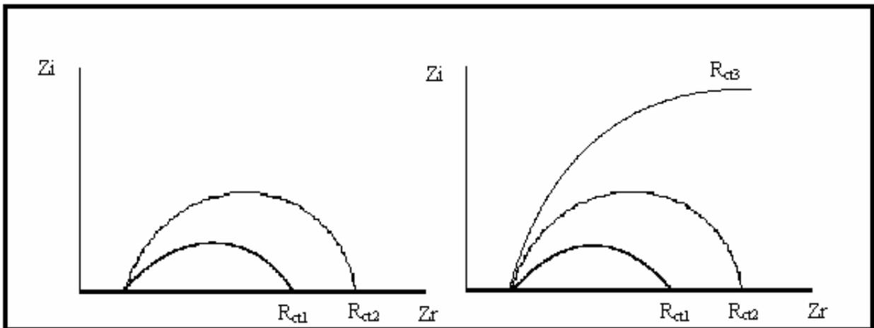
**Figura 3.14:** Diagrama de Impedância de: (A) Filme condutor ( $R_{ct2} < R_{ct1}$ ) e (B) Filme resistivo ( $R_{ct3} (\infty) > R_{ct2} > R_{ct1}$ ).
