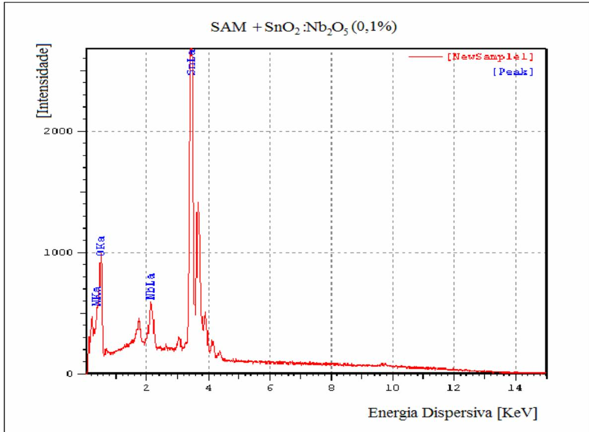
**Figura 4.33:** EDS de amostra de filme de SnO<sub>2</sub>: Nb<sub>2</sub>O<sub>5</sub> (0,1%) com tratamento de SAM antes de sua deposição.
