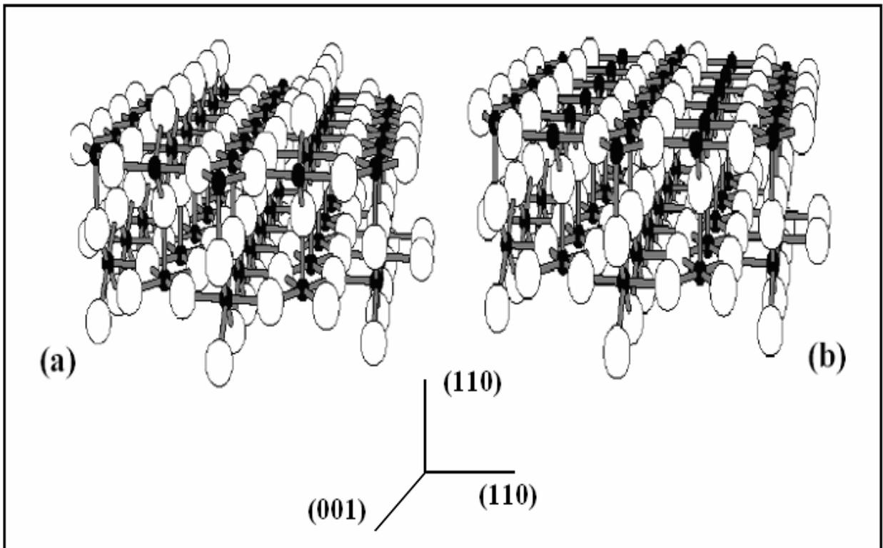
**Figura 2.11:** Superfície do SnO<sub>2</sub> na direção (110). Em (a) observa-se uma camada de oxigênio no topo da figura (superfície estequiométrica); em (b) superfície reduzida tendo a camada de oxigênio removida pelo tratamento térmico a 700°C. Adaptada da referência 29.
