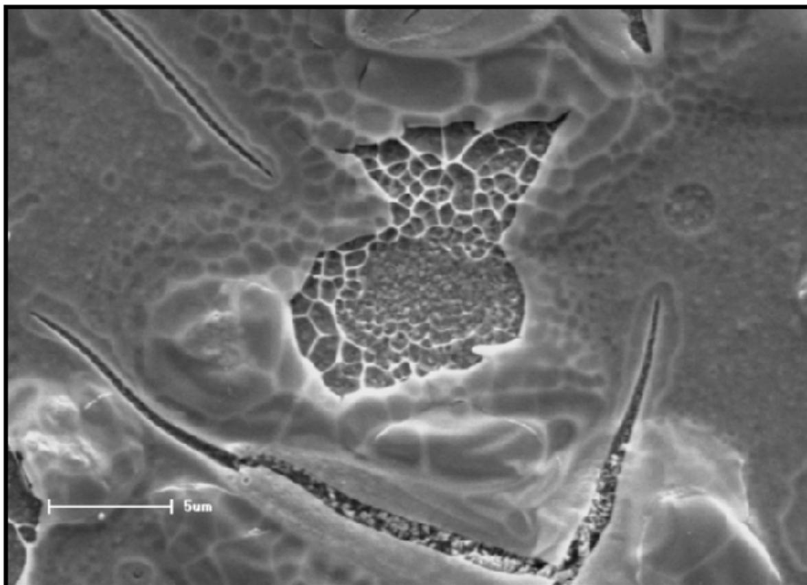
**Figura 4.24:** Micrografia gerada por MEV com agregação de SAM antes da deposição de filme de SnO<sub>2</sub> puro.
