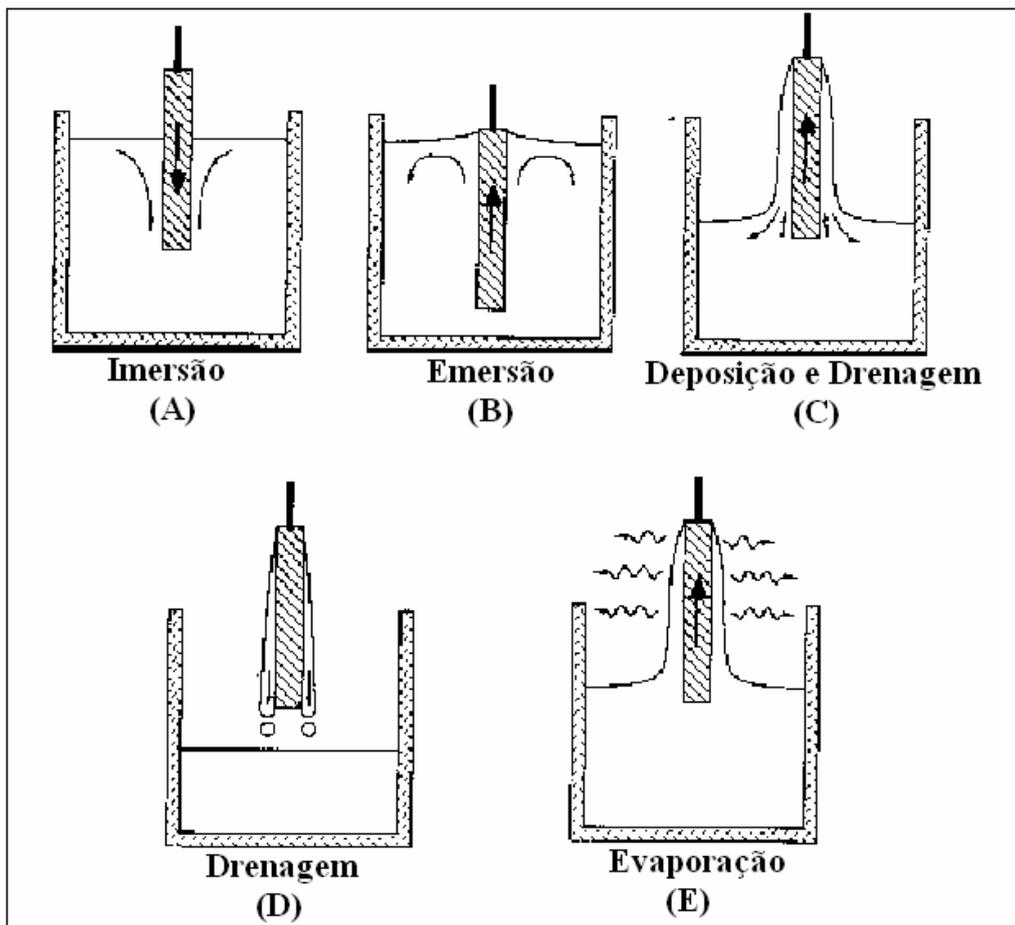
**Figura 2.3:** Estágios durante a formação do filme através da técnica “*dip-coating*”. Imersão e emersão (A e B) ocorrem seqüencialmente, enquanto os três últimos passos (C, D e E) ocorrem simultaneamente. Adaptado da referência 25.
