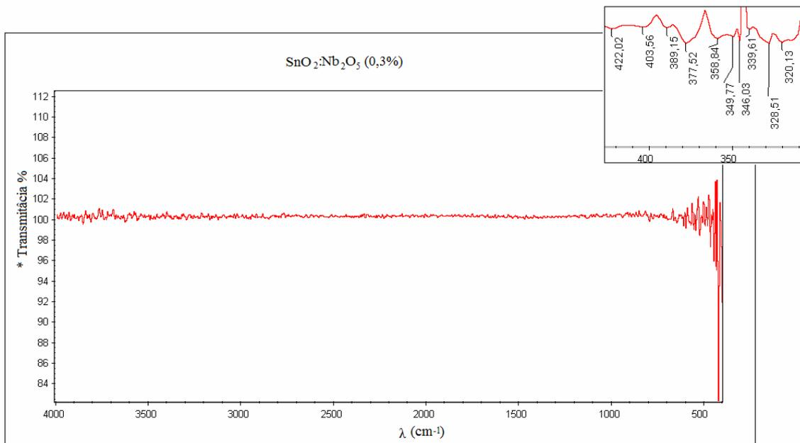
**Figura 4.23:** Espectro de IV referente à amostra de SnO<sub>2</sub>:Nb<sub>2</sub>O<sub>5</sub> (0,3%). Quadro menor: destaque para bandas entre 420 e 300 cm<sup>-1</sup>.
