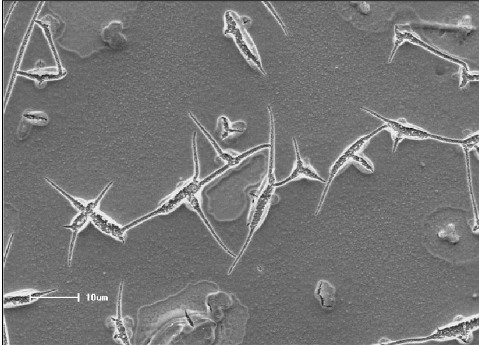
**Figura 4.16:** Micrografia gerada por MEV de amostra de filme de SnO<sub>2</sub>: Nb<sub>2</sub>O<sub>5</sub> (0,1%).
