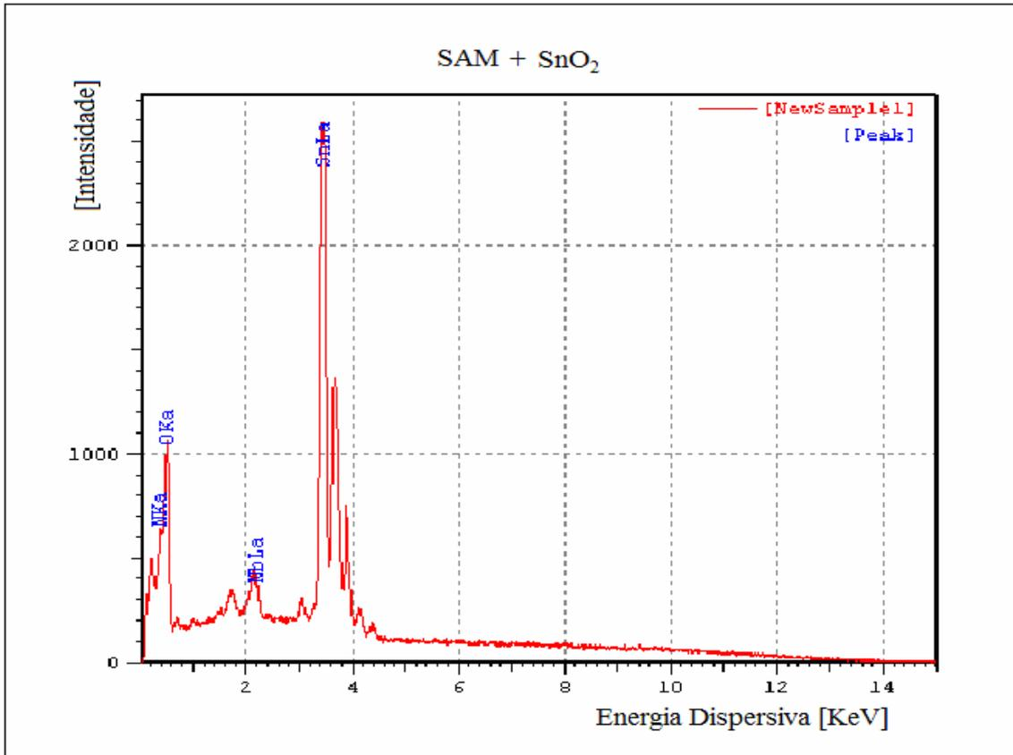
Figura 4.31: EDS de amostra de filme de SnO<sub>2</sub> puro com tratamento de SAM antes de sua deposição.
