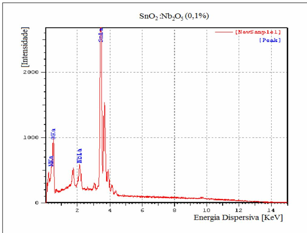
Figura 4.19: EDS de amostra de filme de SnO<sub>2</sub>: Nb<sub>2</sub>O<sub>5</sub> (0,1%).
