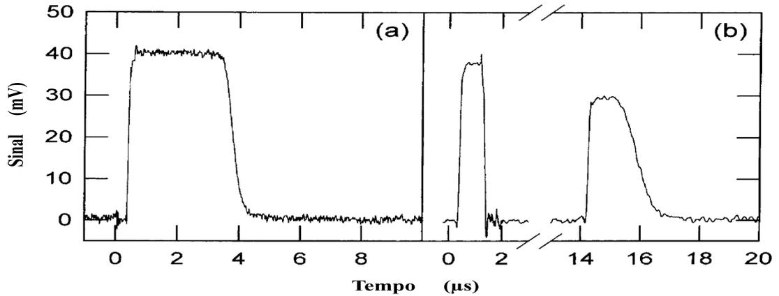
Figura 2.6: (a) Sinal de TOF. O tempo de trânsito é  $3,38 \mu\text{s}$  e a mobilidade é  $0,133 \text{ cm}^2\text{V}^{-1}\text{s}^{-1}$ . (b) Sinal de IFTOF, após  $1 \mu\text{s}$  o campo é interrompido por  $12 \mu\text{s}$ . (Adaptado de [50])
