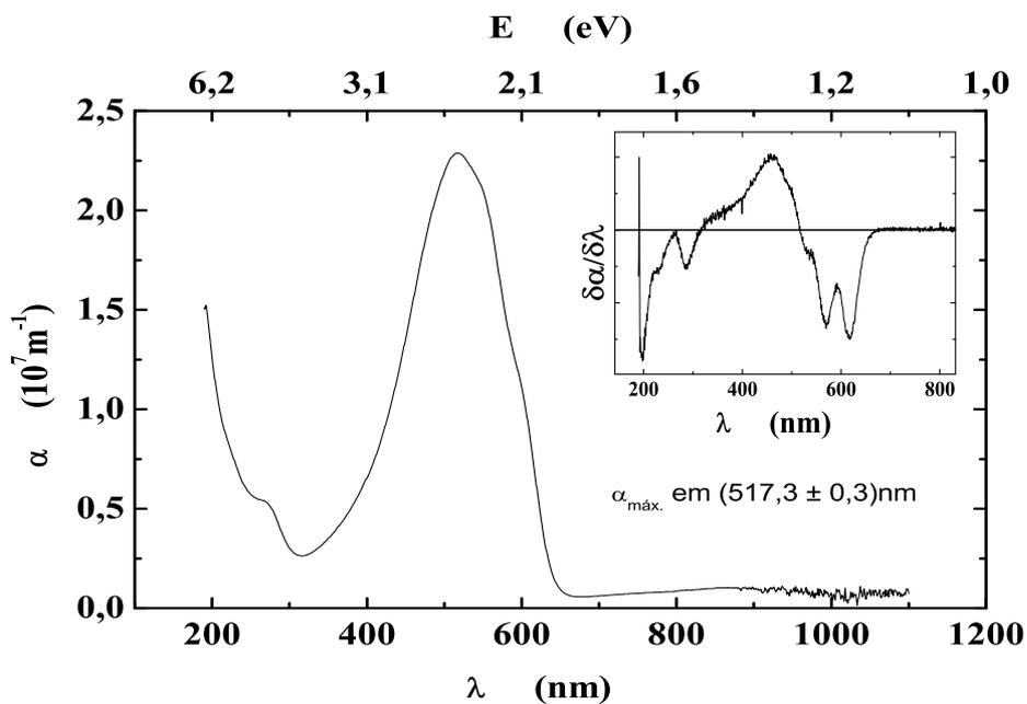
Figura 4.10: Coeficiente de absorção do PHT. A inserção mostra a derivada do gráfico feita para determinar os máximos e mínimos locais.
