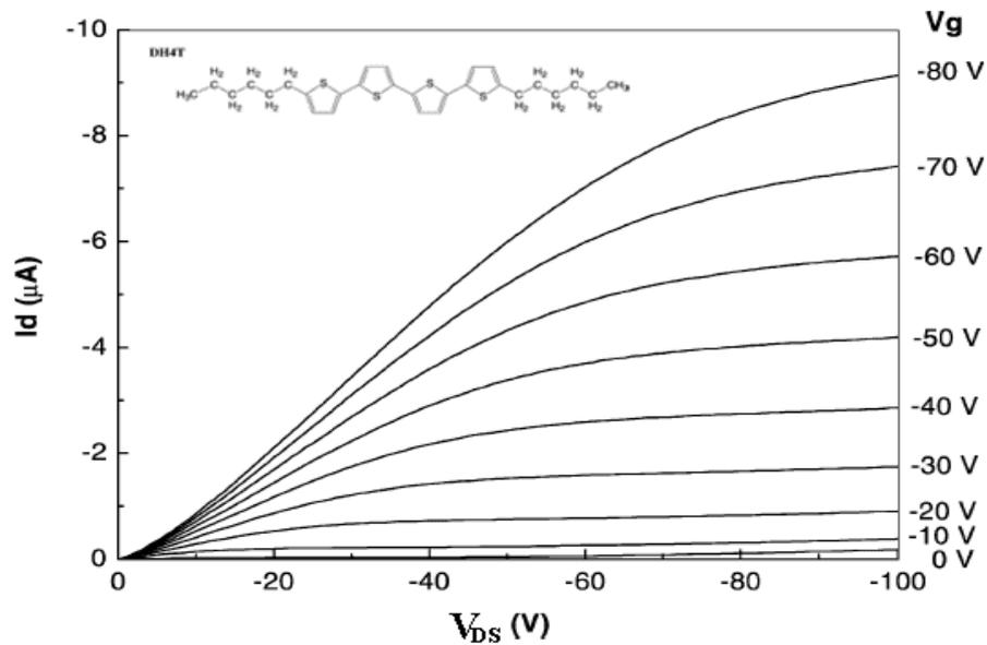
Figura 2.9: Exemplo típico de curvas de transferência em um FET orgânico feito com um derivado de tiofeno. (Adaptado de [67]).
