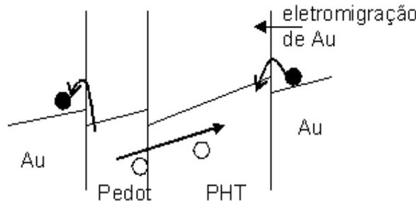
Figura 5.2: Polarização reversa, num dispositivo de “somente buracos”, os buracos são criados na interface Au/PEDOT por extração de um elétron da banda de valência. Os buracos são recombinados com elétrons na interface Au/PHT. Buracos representados por circunferências e elétrons representados por círculos pretos.
