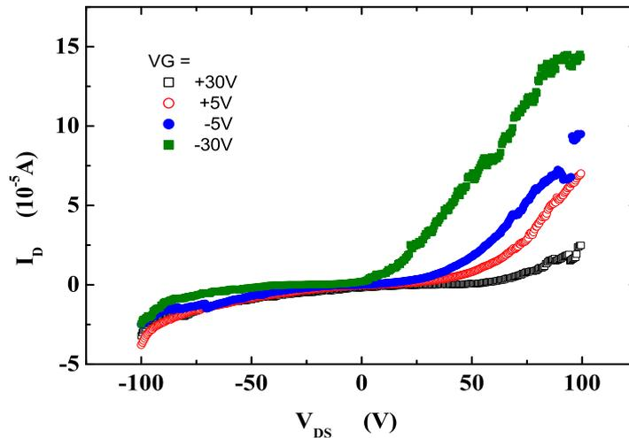
Figura 4.28: Curvas de transferência para FETs de Au/PHT( $23\ \mu\text{m}$ )/Au com portão feito de FTO/SiO<sub>2</sub>(40 nm).
