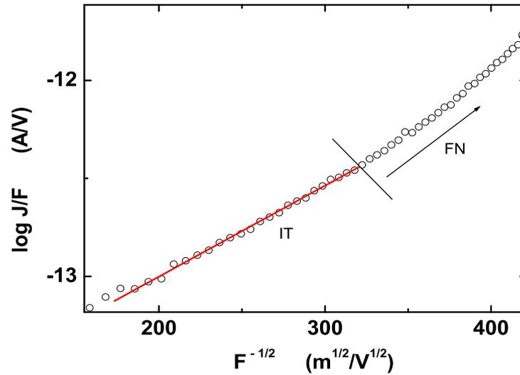
Figura 4.5: Gráfico de Injeção termoiônica de um dispositivo Au/PEDOT/PHT/Au, indicando a região limitada por injeção termoiônica e a região onde a corrente de tunelamento domina a injeção.
