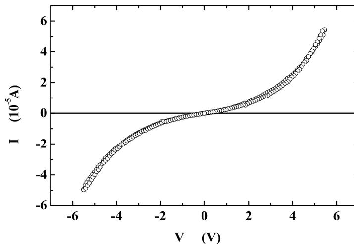
Figura 4.1: Medida  $I \times V$  para um dispositivo Au (106 nm) / PEDOT (63 nm) / PHT (332 nm) / Au (72 nm) injetando buracos pelo Au no primeiro quadrante. Tensões positivas significam eletrodo de Au/PEDOT polarizado negativamente em relação ao outro eletrodo.
