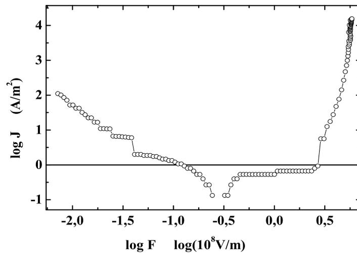
Figura 4.7: Medida  $J \times F$  de um dispositivo Au/PHT/Al. Este gráfico mostra uma retificação de até 3 ordens de grandeza, dependendo da tensão comparada. Os degraus da medida são artefatos da mesma (limite de resolução do equipamento para uma determinada escala).
