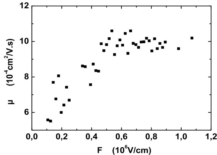
Figura 4.16: Mobilidade obtida pelo ajuste de retas dos gráficos  $\log I(t) \times \log(t)$ , segundo Scherr e Montrol.
