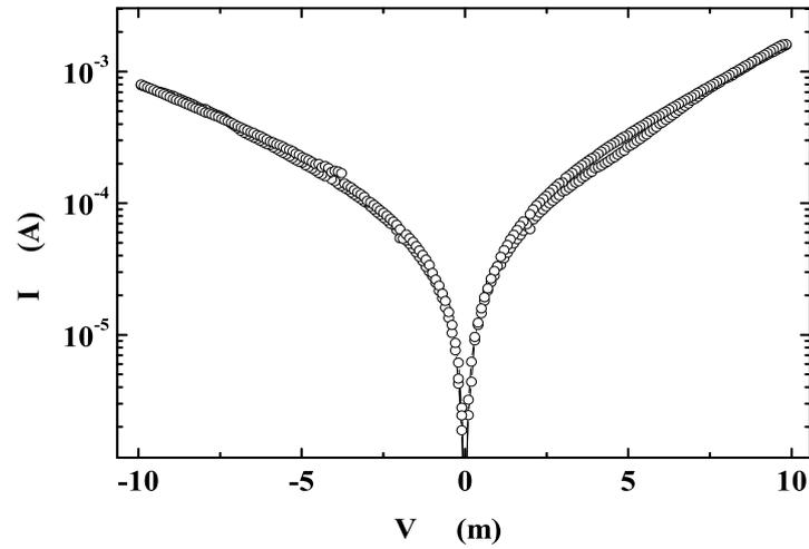
Figura 4.2:  $\log I \times V$  mostrando pequena retificação do dispositivo Au / PEDOT / PHT / Au
