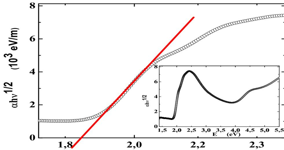
Figura 4.11: Gráfico de Davis-Mott para determinar a largura da banda proibida  $E_g = 1,8$  eV. Inserção: mesmo gráfico com faixa de energia estendida.
