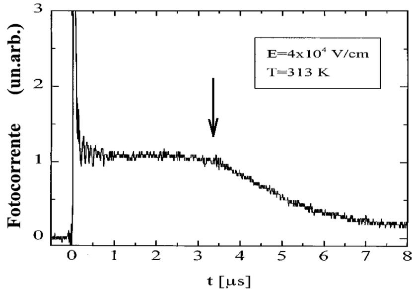
Figura 2.5: Sinal típico de TOF em poliparafenileno-metil-substituído (MeLPPP) em uma configuração ITO/MeLPPP(1  $\mu\text{m}$ )/Al(150 nm), com excitação feita com terceiro harmônico de um laser Nd:YAG. A seta indica o tempo de trânsito. (adaptado de [37])
