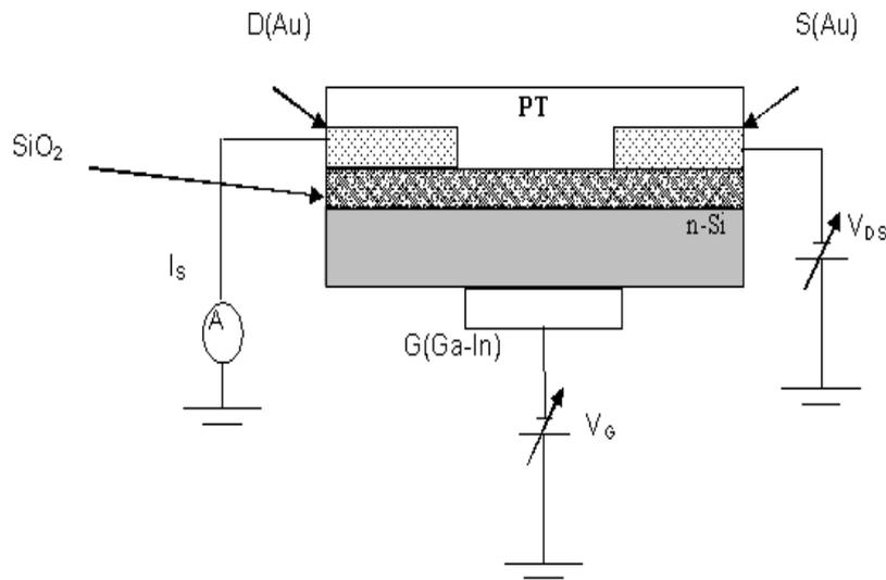
Figura 2.8: Vista da secção transversal de um FET construído com portão (G) de n-Si, isolante do portão com SiO<sub>2</sub>, PT como camada ativa e eletrodos de Au como fonte (S) e dreno (D). Adaptado de [63].
