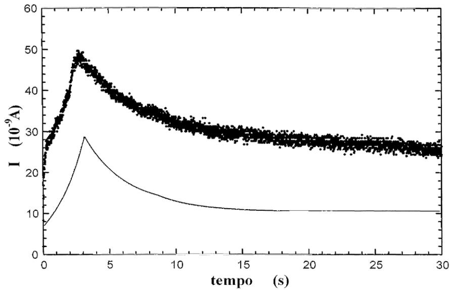
Figura 2.15: *Transiente de corrente em dispositivo Au/PPV(200  $\mu\text{m}$ )/Au para uma tensão aplicada de 350 V. A linha sólida é o cálculo teórico para um material isolante sem armadilhas. O valor de mobilidade obtido para o PPV foi  $4,2 \times 10^{-7} \text{ cm}^2\text{V}^{-1}\text{s}^{-1}$ . (Adaptado de [88])*
