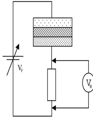
Figura 3.3: Circuito de medida em forma de divisor resistivo. As quedas de tensão sobre o resistor e a tensão aplicada são utilizadas para calcular a corrente através deste e a queda de tensão sobre a amostra.
