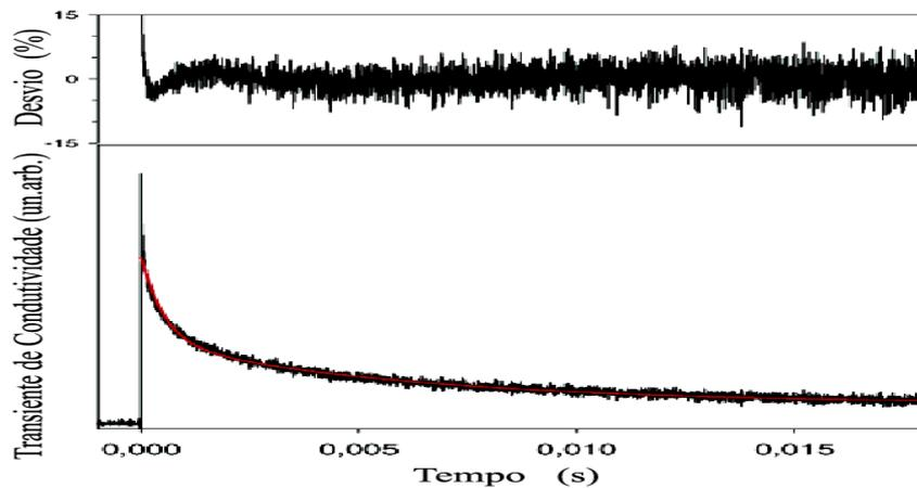
Figura 2.14: Sinal de decaimento da condutividade após um pulso de elétrons, medido por microondas. Em cima o desvio do ajuste de uma exponencial dupla. Adaptado de [85].
