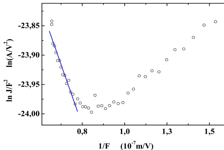
Figura 4.4: Gráfico de Fowler-Nordheim para um dispositivo Au/PEDOT/PHT/Au injetando buracos pelo Au, coef. angular =  $-8,23 \times 10^6 \text{ Am/v}^3$  fornece da uma altura efetiva de barreira de 11,3 meV entre o Au e o PHT em temperatura ambiente.
