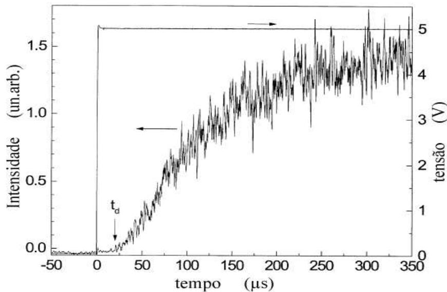
Figura 2.7: Gráfico de intensidade de eletroluminescência em TPD/Alq<sub>3</sub> em função do tempo, mostrando também o pulso elétrico aplicado.  $t_d$  é o tempo de início da emissão. Adaptado de [59].
