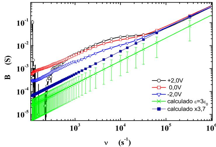
Figura 4.25: Espectros de susceptância ( $B$ ) em função da frequência aplicada num dispositivo Au (106 nm) / PEDOT (63 nm) / PHT (248 nm) / Au (72 nm), para diversas tensões constantes aplicadas. A amplitude do sinal C.A. é de 500 mV.
