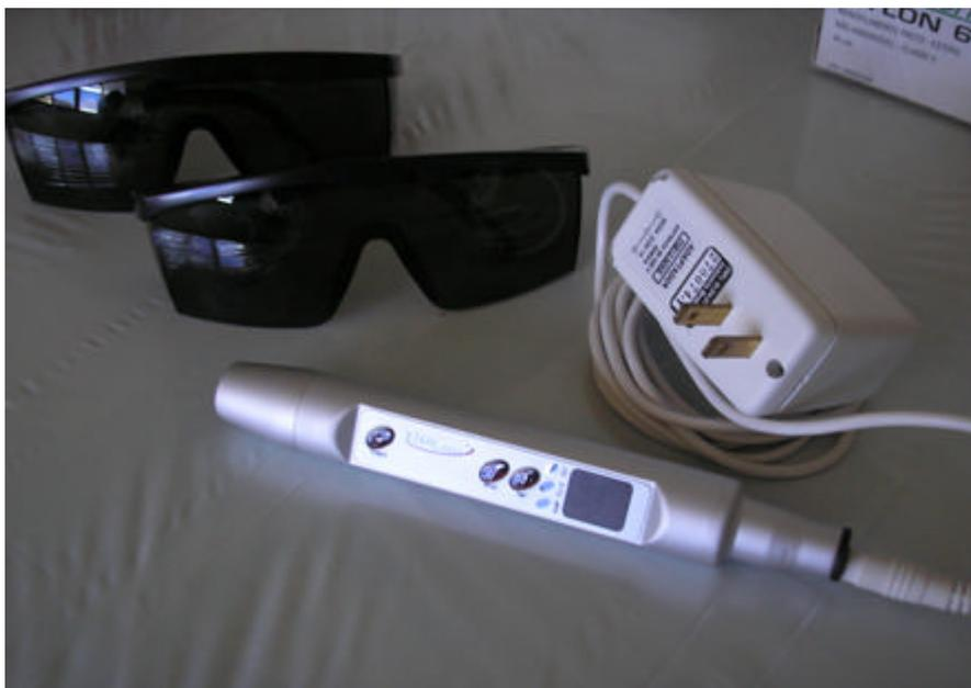
**Figura 10:** Aparelho LED Microdont, caneta com comprimento de onda de 640nm e par de óculos para proteção.
