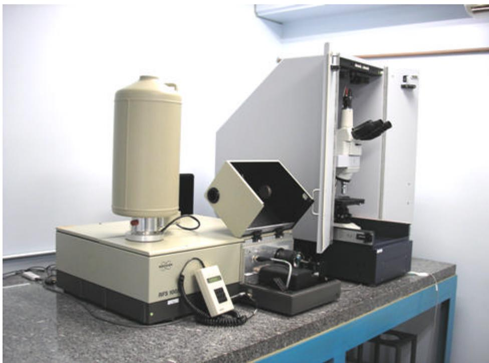
**Figura15:** Equipamento FT-Raman *Spectrometer*RFS 100 - Bruker ®.
