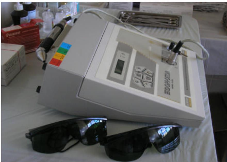
**Figura 8:** Aparelho laser KLD, caneta aço inox com comprimento de onda de 904nm e par óculos para proteção.
