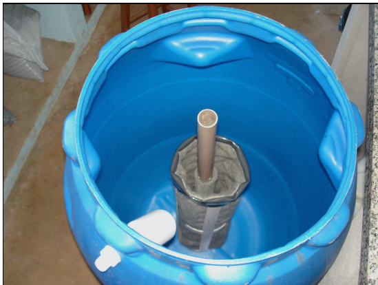
Figura 4.18 – Reservatório de 200L com a coluna instalada.
