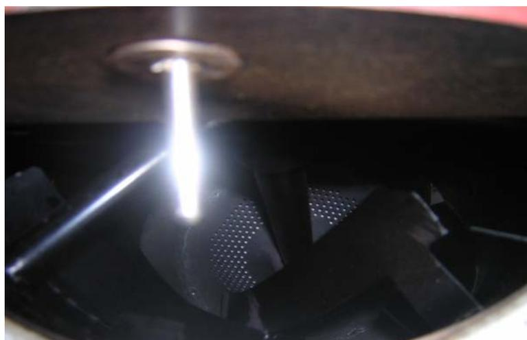
**FIGURA 7** Localização da haste do termopar na porta da câmara de torração aberta.
