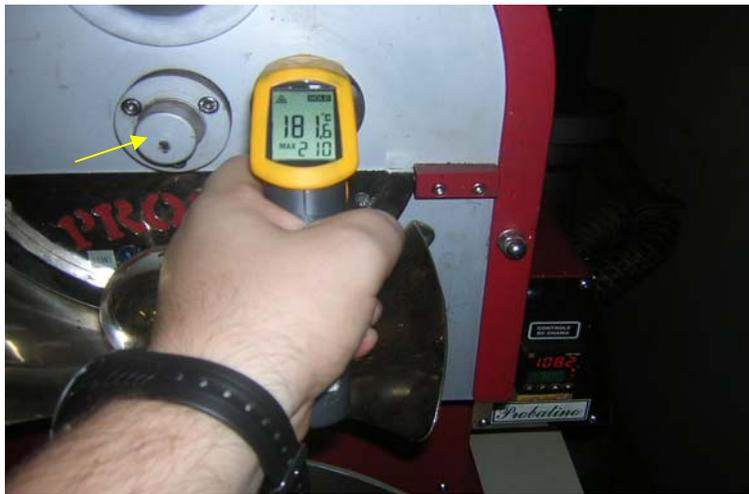
**FIGURA 8** Localização do termômetro a laser para monitoramento da temperatura de torração.
