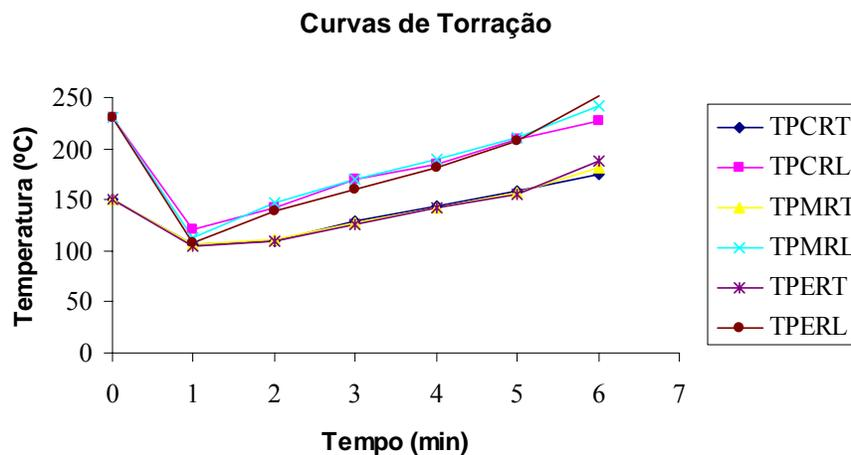
**FIGURA 12** Curvas de torração rápida aplicada no o café passa, para obtenção das três tonalidades de cor clara, média e escura. Representadas pelas seguintes siglas TPCRT (torração Passa clara rápida termopar), TPCRL (torração passa clara rápida laser), TPMRT (torração passa média rápida termopar), TPMRL (torração passa média rápida laser), TPERT (torração passa escura rápida termopar), TPERL (torração passa escura rápida laser).
