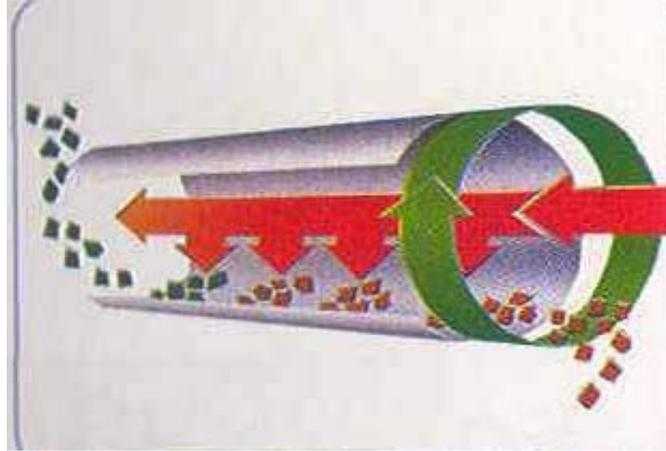
**FIGURA 2** Desenho da câmara de torração dos torradores de fluxo contínuo. (Probat, 2004).
