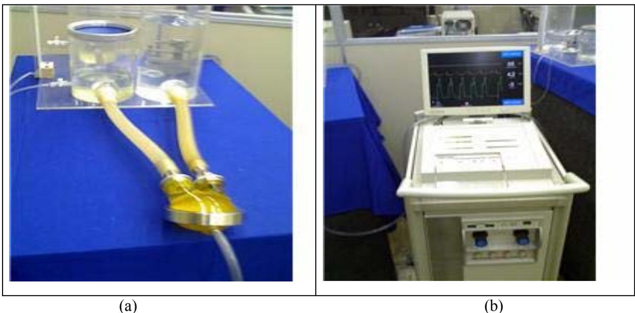
Figura 4.2: (a) Coração artificial, (b) máquina de fluxo.
