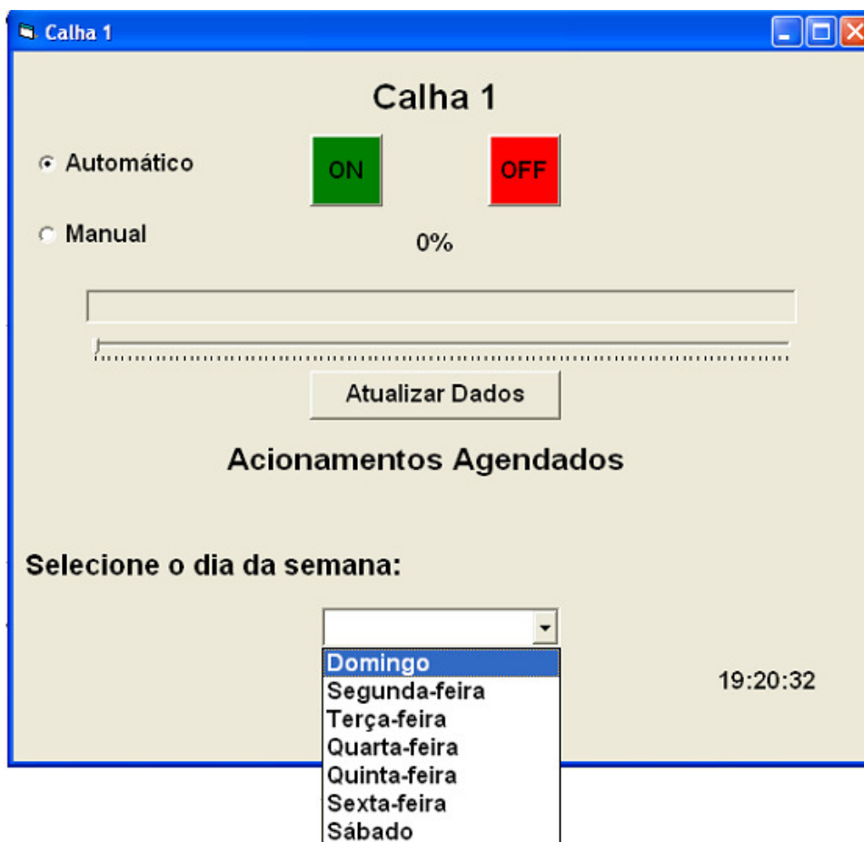
Figura 5.11: Formulário do aplicativo de controle por calha do sistema de iluminação.
