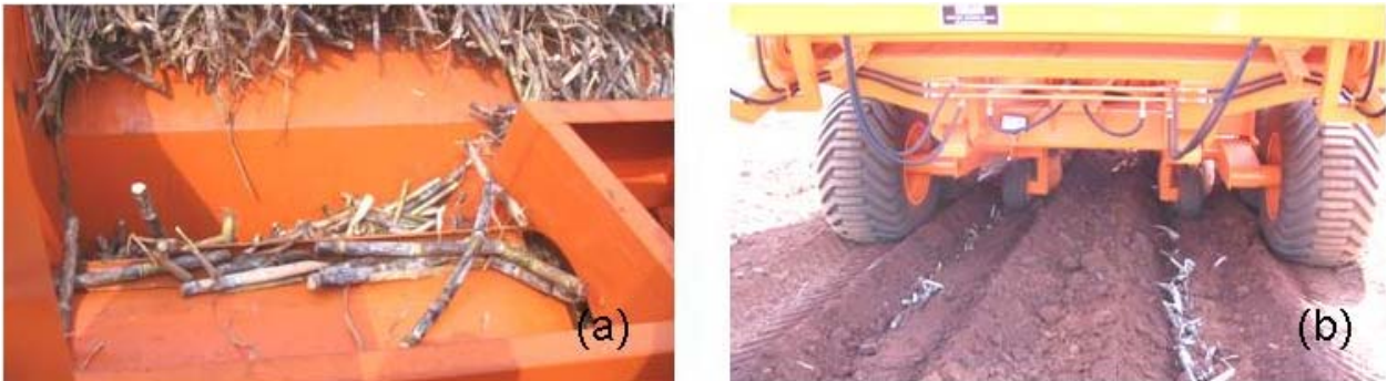
Figura 7 – Regulagem da velocidade da esteira (a) e do cobridor de sulco (b)
