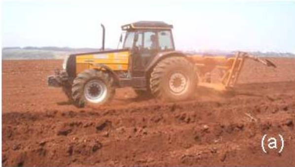
Figura 1 – Sulcação e adubação no sistema semimecanizado (a e b)
