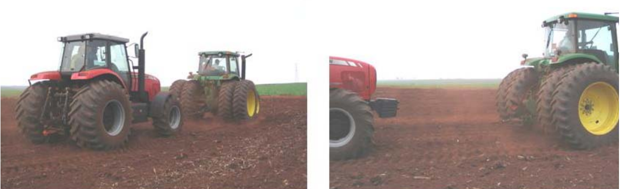
Figura 24 – Configuração para determinação do esforço tratorrio
