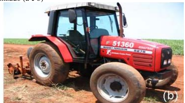
Figura 4 – Operação de cobrimento de colmos no sistema semimecanizado (a). Trator usado no cobrimento de colmos com pneus lisos para não danificar gemas (b)
