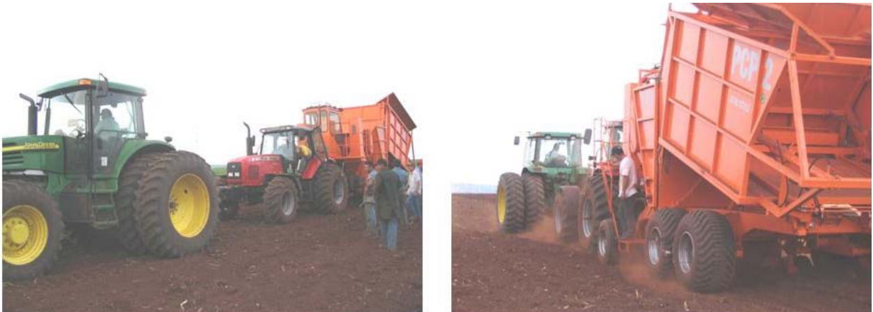
Figura 23 – Configuração para determinação da força de tração
