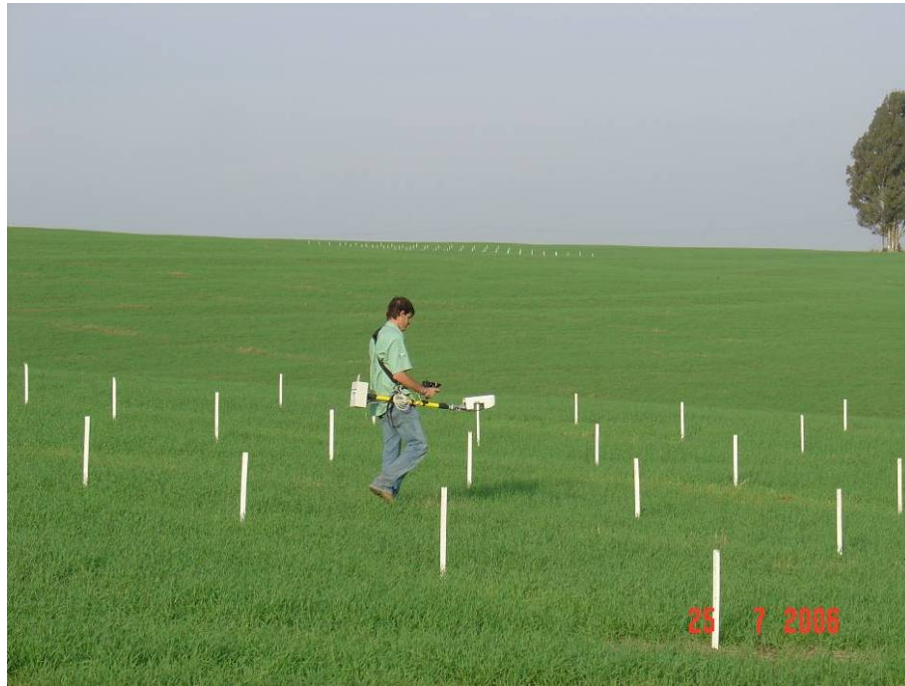
Figura 2 – Coleta de dados com o sensor óptico ativo no Experimento 1
