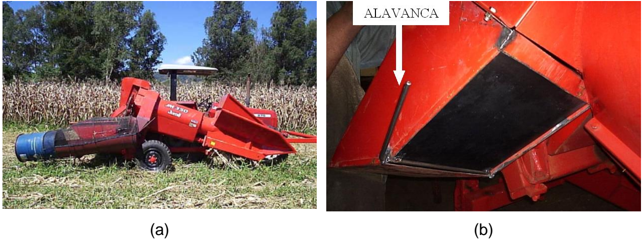
Figura 5 – Vista lateral do reservatório de palha (a) e detalhes do direcionador de fluxo desenvolvido (b)
