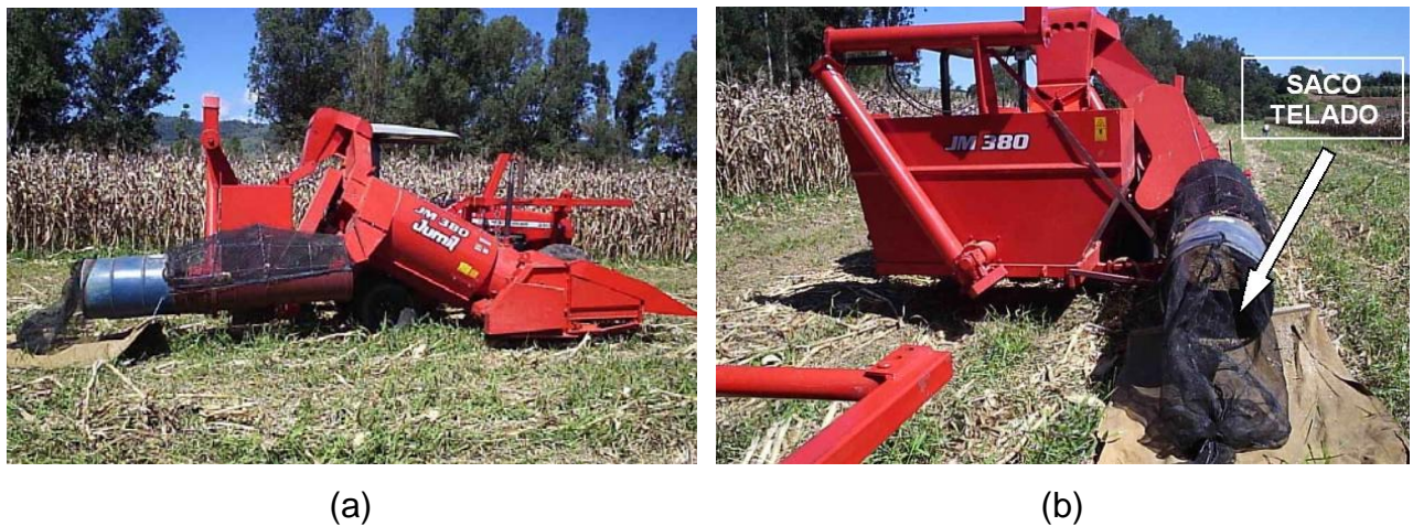
Figura 6 – Vista lateral do reservatório de palha da colhedora de duas linhas (a) vista da parte de trás do reservatório de palha da colhedora (b)
