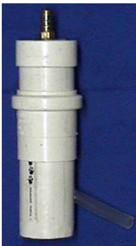
Figura 15 - Reservatório de água do manômetro
