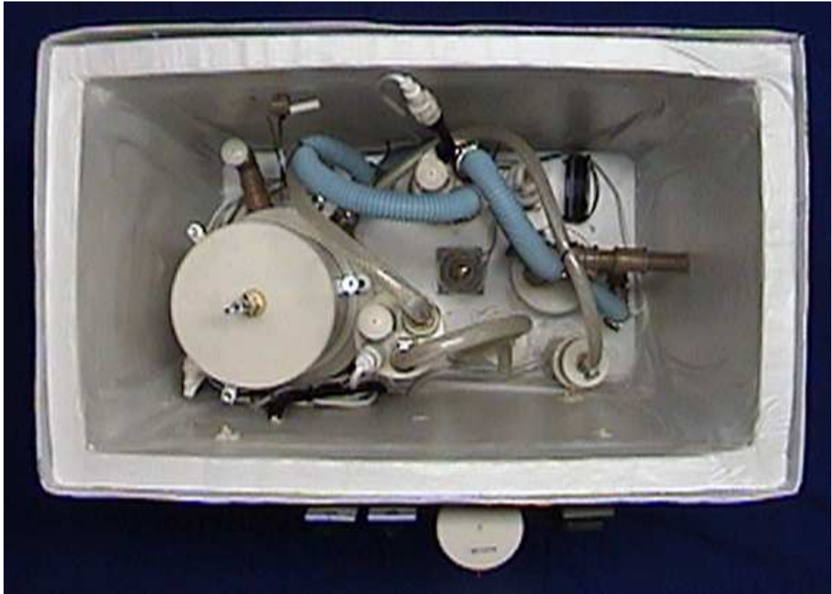
Figura 24 - Montagem do Pulmão Artificial: interior montado
