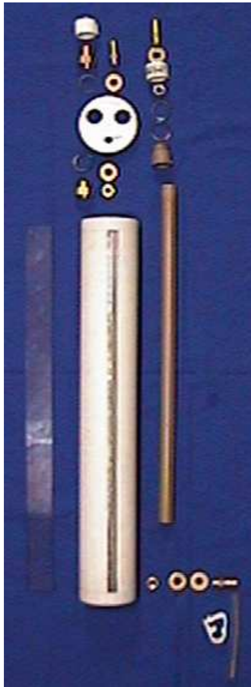
Figura 5 - Válvula de Segurança desmontada
