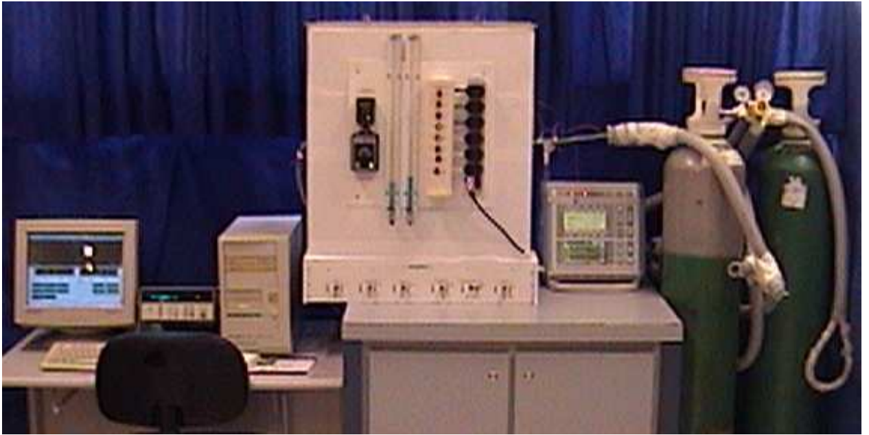
Figura 27 -Pulmão Artificial ativado sob Ventilação Mecânica e com coleta computadorizada de dados (variáveis)
