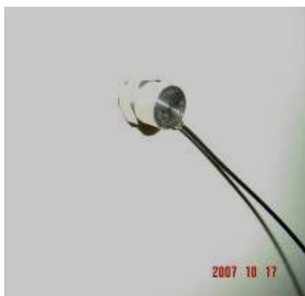
Figura 4.5 - Foto Acelerômetro Piezoelétrico utilizado nas medições
