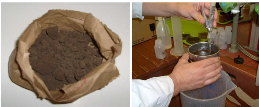
FIGURA 3 - Amostra de solo e sua lavagem, após agitação por 15 h, com jato d'água leve, para separação das frações em peneira de 0,063 mm. Freiburg, 2007.
