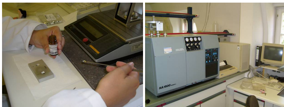
FIGURA 7 - Montagem das cápsulas e análise dos teores de carbono e nitrogênio em aparelho CNS, via digestão seca. Freiburg, 2007.
