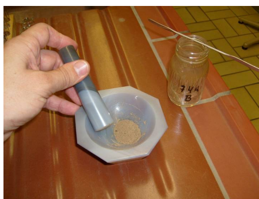
FIGURA 6 - Moagem de amostra em gral para posterior análise de carbono e nitrogênio. Freiburg, 2007.
