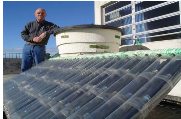
Figura 36 – Foto do Sistema de Aquecimento Solar com Pets e seu inventor ao fundo: José Alcino Alano
