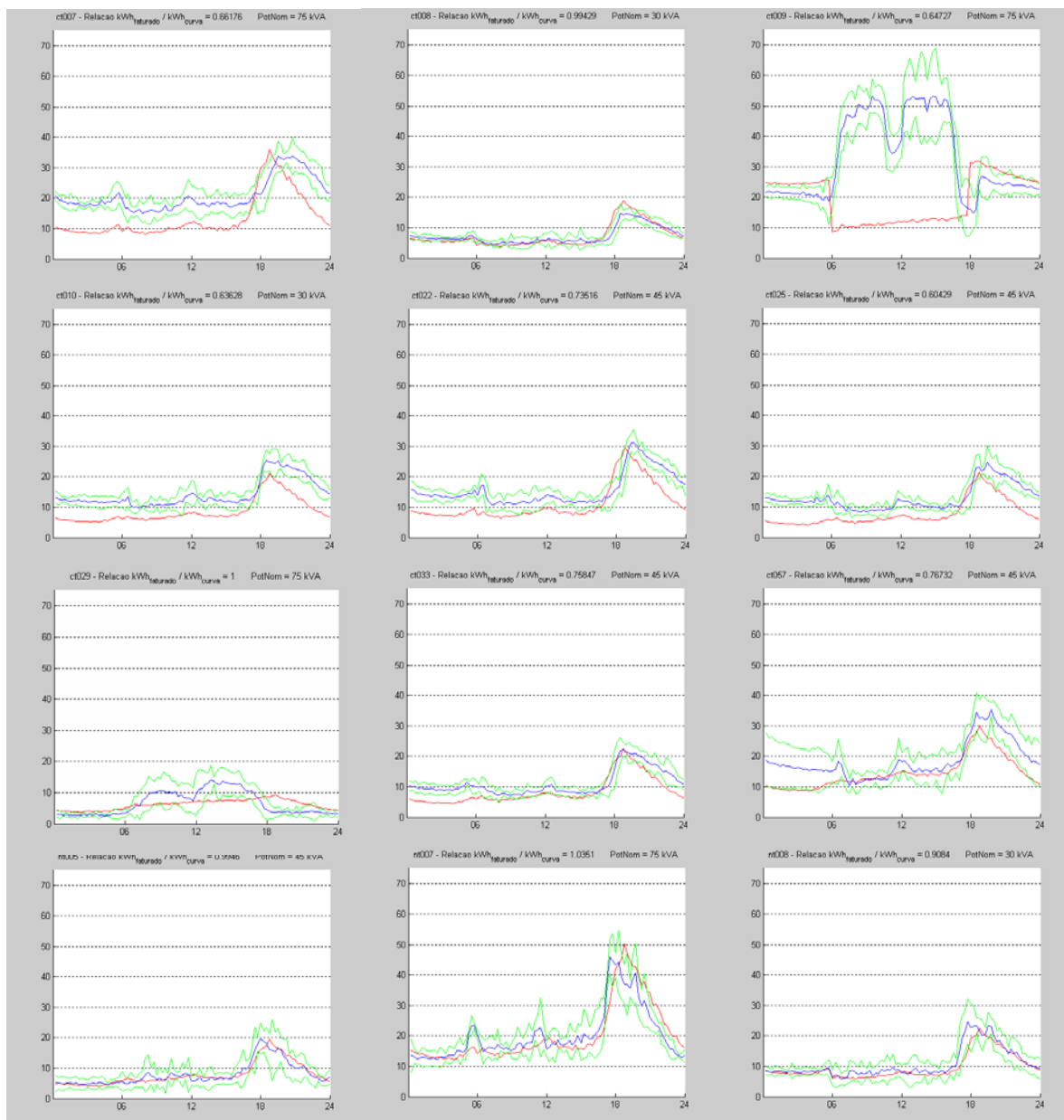
Figura 4.13 - Curvas estimada versus medida em 12 transformadores da amostra para k=10.
