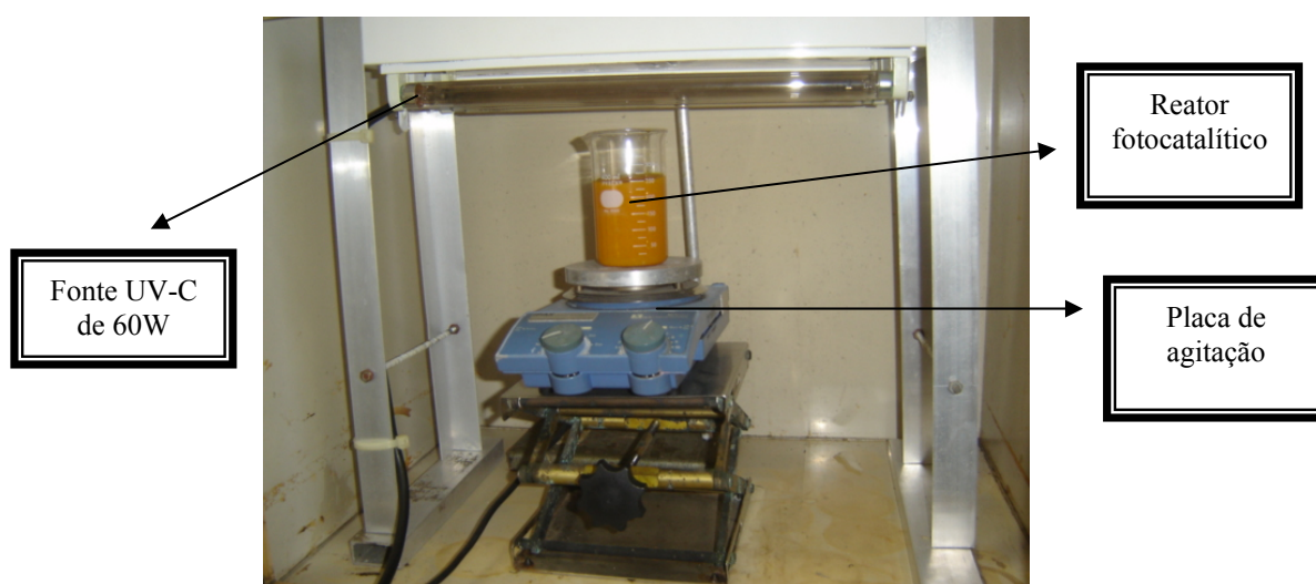
Figura 3.4. Sistema experimental do processo fotocatalítico em batelada, sem a aeração do sistema e sob a fonte UV-C de 60W.
