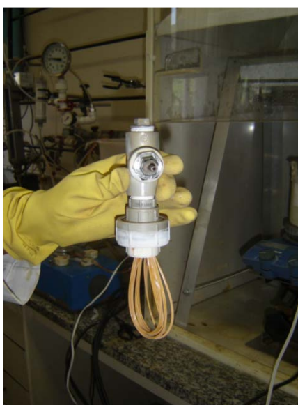
Figura 4.30. Fotografia do módulo de MF após 1 mês de operação.
