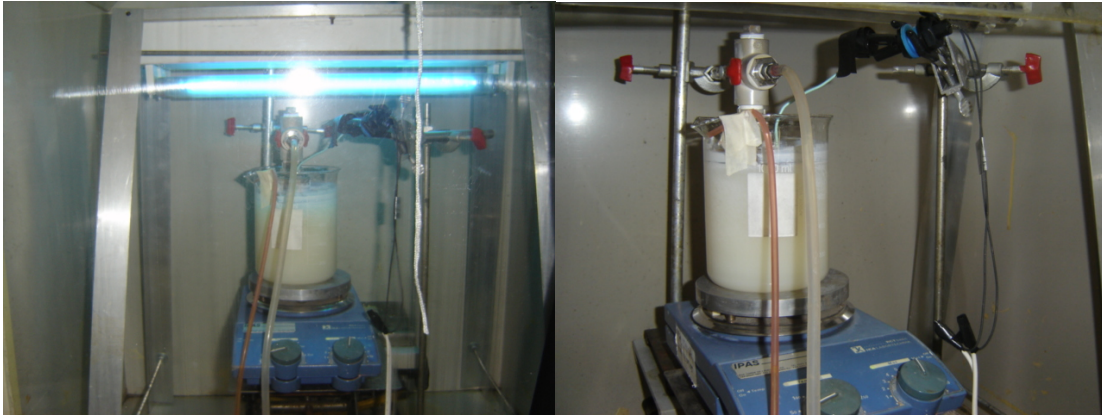
Figura 3.9. Sistema fotocatalítico contendo um feixe de fibras ocas imerso no meio reacional. (a) detalhe da fonte de UV-C; (b) detalhe da saída de permeado.
