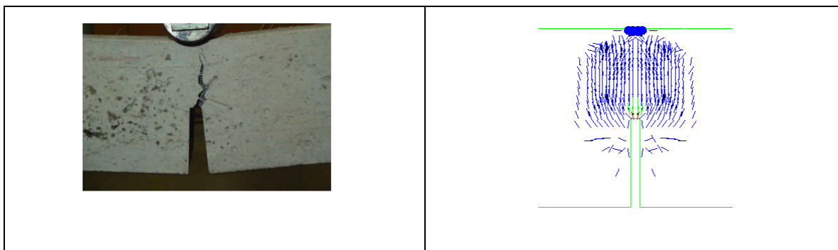
Figura 3.15 – Comparação entre o modo de fratura experimental e numérico.
