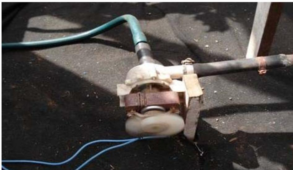
Figura 2 - Eletrobomba utilizado para circulação da solução nutritiva
