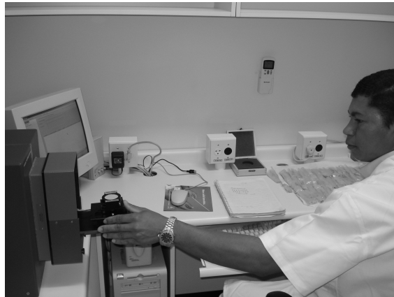
FIGURA 6.1 Equipamento NIR utilizado na análise de lignina.
