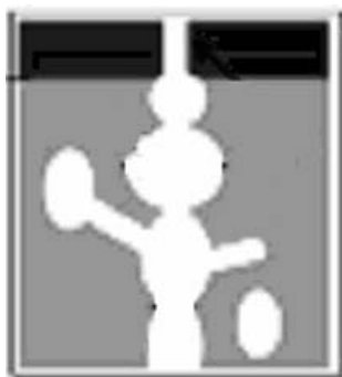
Figura 31. Desenho esquemático da estrutura porosa de uma membrana de carbono. A região cinza representa a matriz de carbono e a região clara os poros [7].
