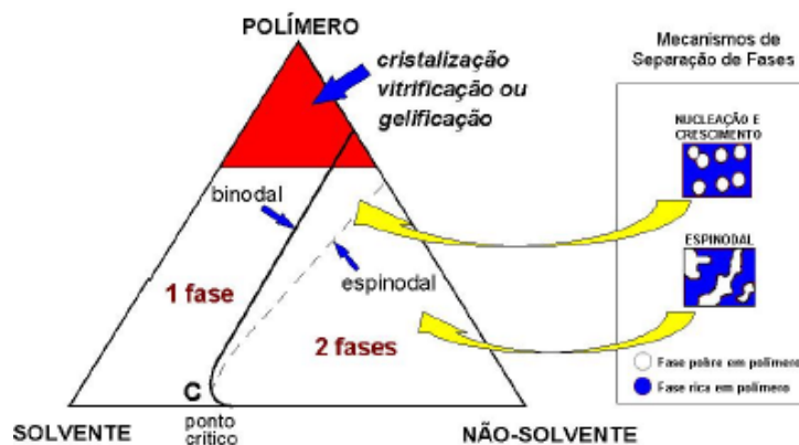
Figura 33. Ilustração do diagrama de fases do sistema ternário: polímero, solvente e não solvente e indicação dos mecanismos de separação de fases líquido-líquido [17].
