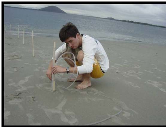
Figura 8. Praia de Itacuruçá, Ilha do Cardoso-SP. Medida do perfil da praia pelo Método dos Vasos Comunicantes.
