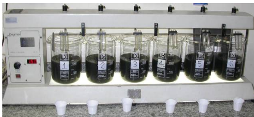
Figura IV.3: Equipamento de Teste de Jarro Digimed, modelo módulo floculador Mf-01
