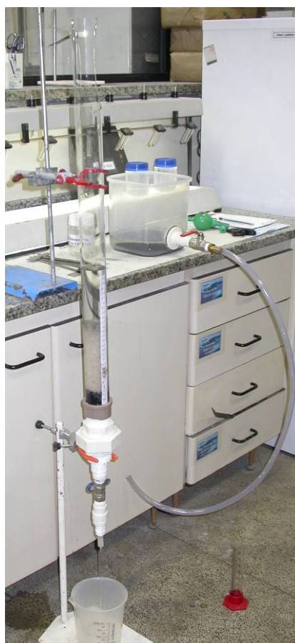
Figura IV.9 - Módulo de coagulação/floculação e Filtração
