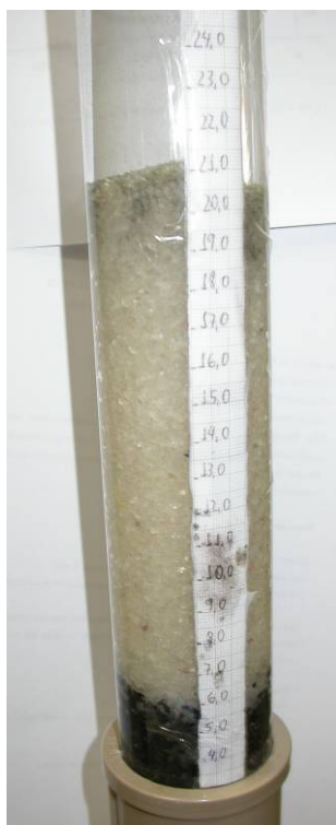
Figura IV.8 – Filtro de laboratório com o leito de areia e carvão
