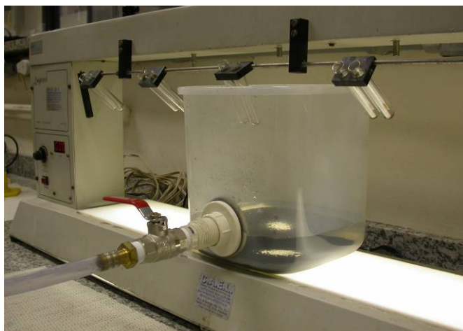
Figura IV.7 – Reator de 4,0L de coagulação/Floculação e sedimentação
