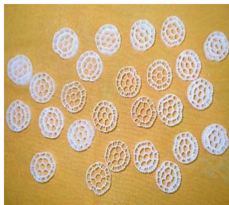
Figura 18: Suportes utilizados para a adesão dos microrganismos: (a) AMB ® ; (b) Kaldnes ® K3.
