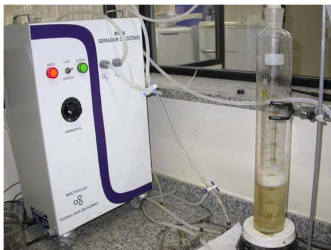
Figura 21: Aparato experimental do teste com ozônio, composta pelo gerador de ozônio e pela coluna de ozonização.
