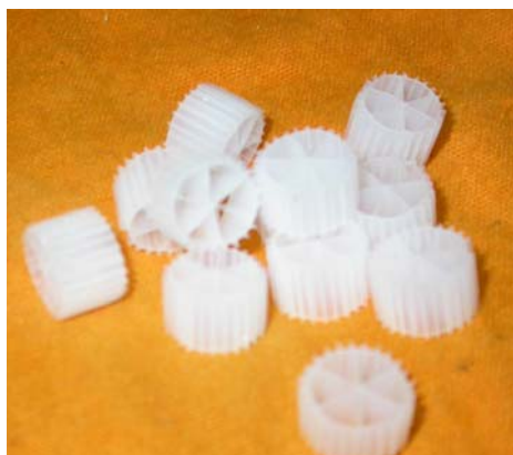
Figura 18: Suportes utilizados para a adesão dos microrganismos: (a) AMB ® ; (b) Kaldnes ® K3.
