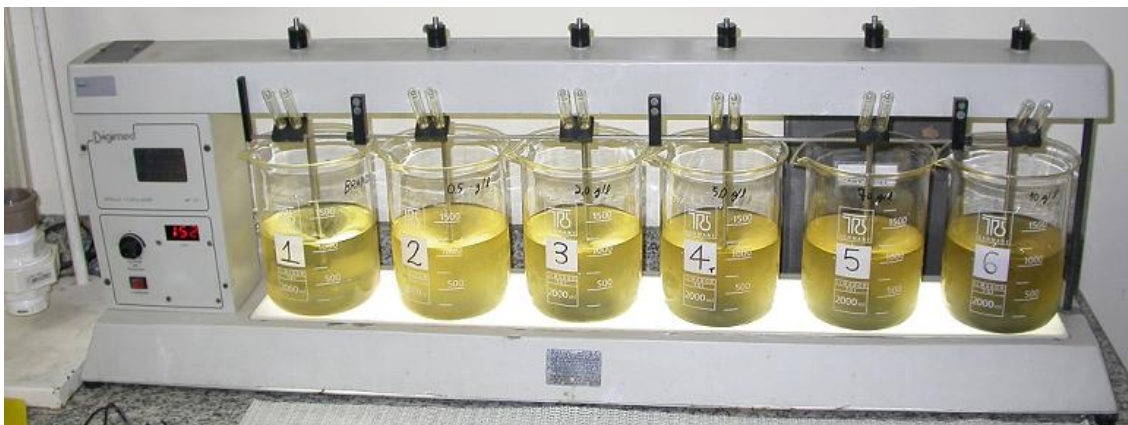
Figura 19: Foto ilustrativa do equipamento utilizado para o teste de jarro com carvão ativado granulado, no qual variou-se a concentração de CAG de 0,5 a 10 g.L -1 .
