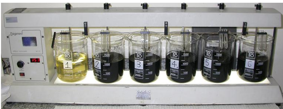
Figura 20: Foto ilustrativa do equipamento utilizado para o teste de jarro com carvão ativado em pó, no qual variou-se a concentração de CAP de 0,5 a 10 g.L -1 .
