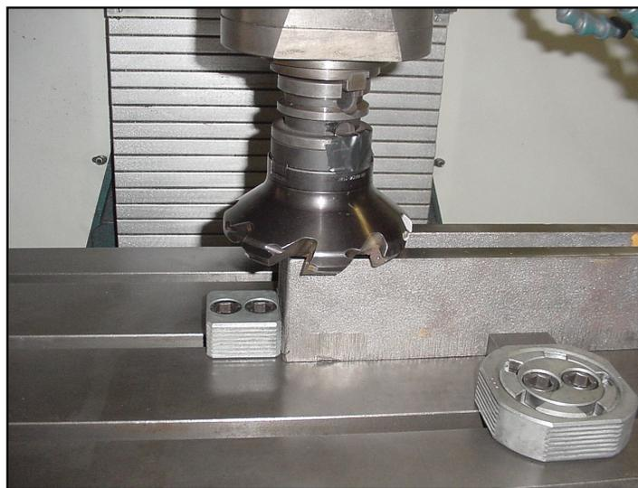
Figura 2.6 – Representação de um fresamento frontal.
