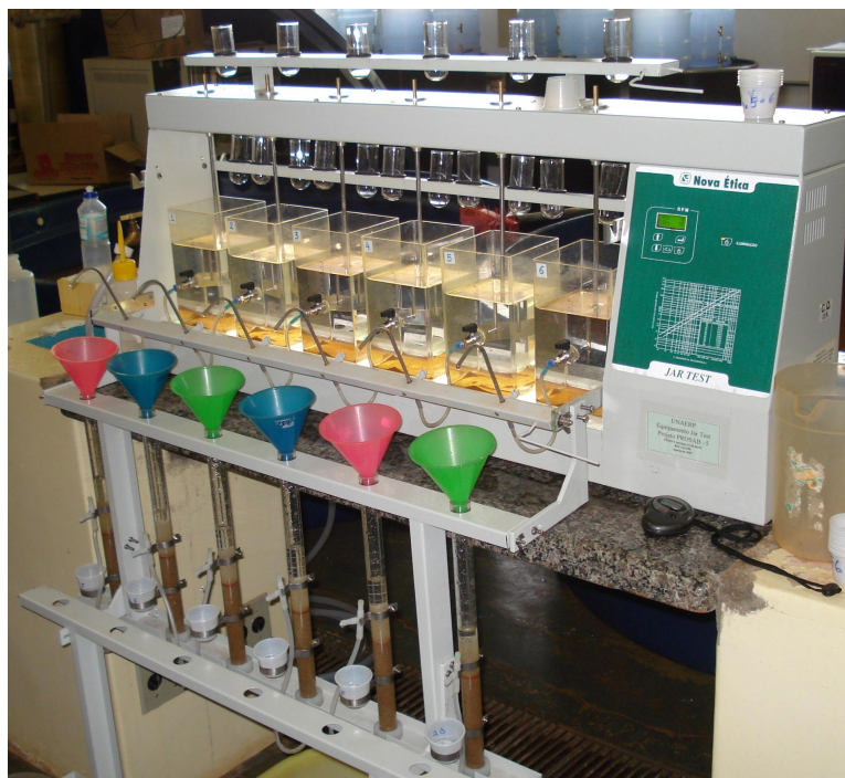
Figura 5.19: Foto do ensaio em ciclo completo sem o uso de CAP.
