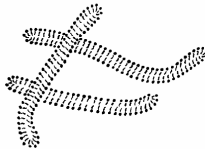
Figura 24. Representação esquemática de uma rede micelar formada por agregados longitudinais (Yang, 2002).
