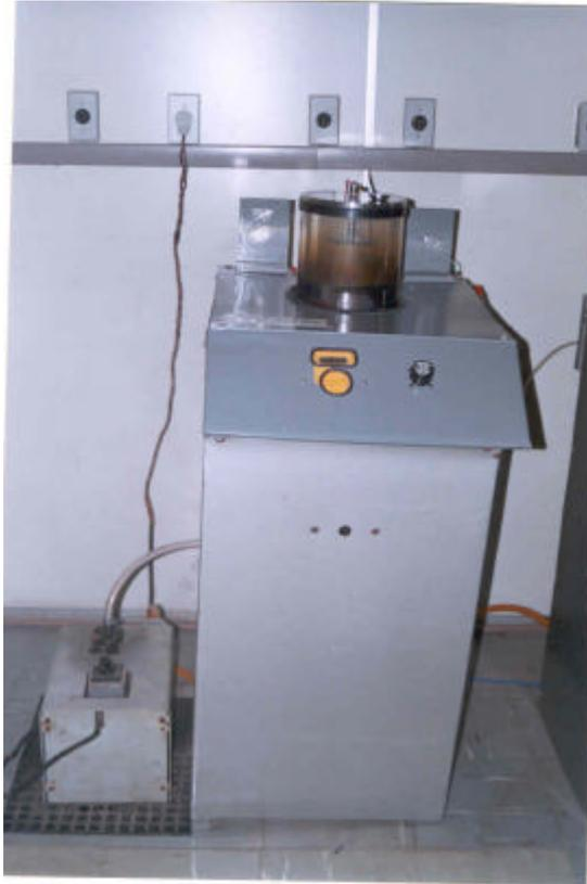
Anexo 7. Vista frontal do equipamento usado no tratamento térmico por Plasma
