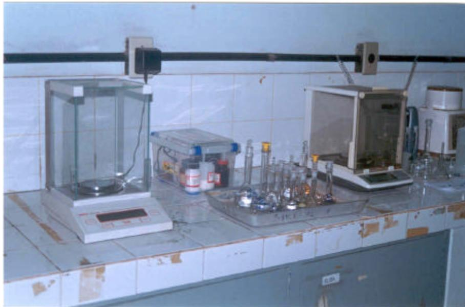
Anexo 4. Vista da bancada de preparação para ensaios Absorção Atômica e Plasma
