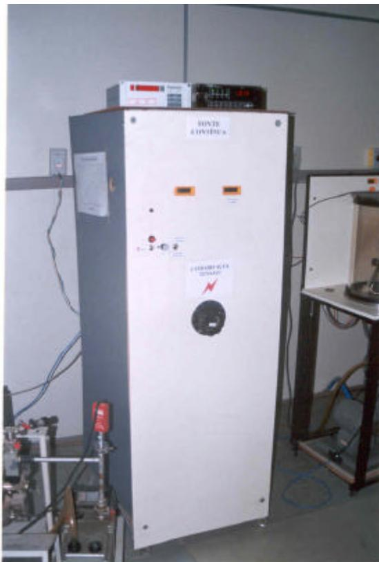
Anexo 8. Vista frontal da fonte de alta tensão para ensaios com o Plasma
