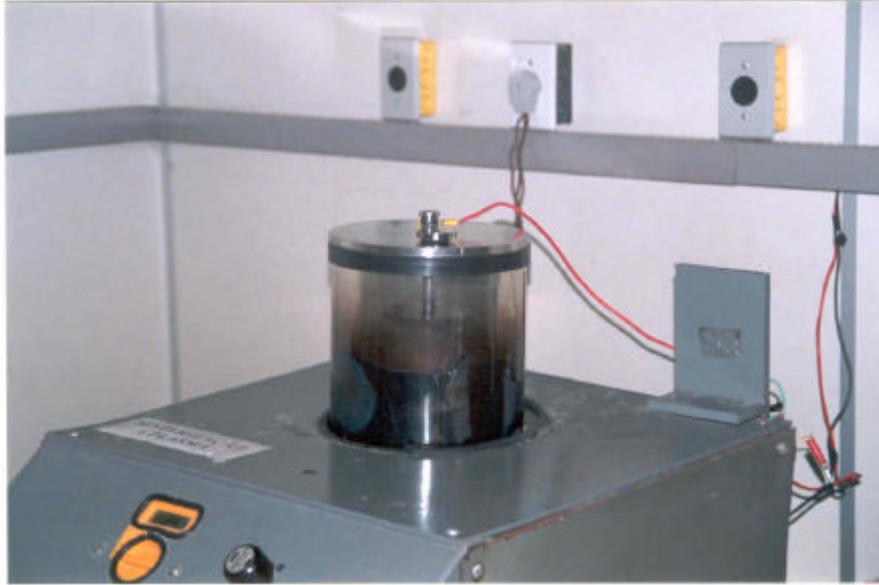
Anexo 5. Vista da câmara de redução com medidor de corrente elétrica em foco
