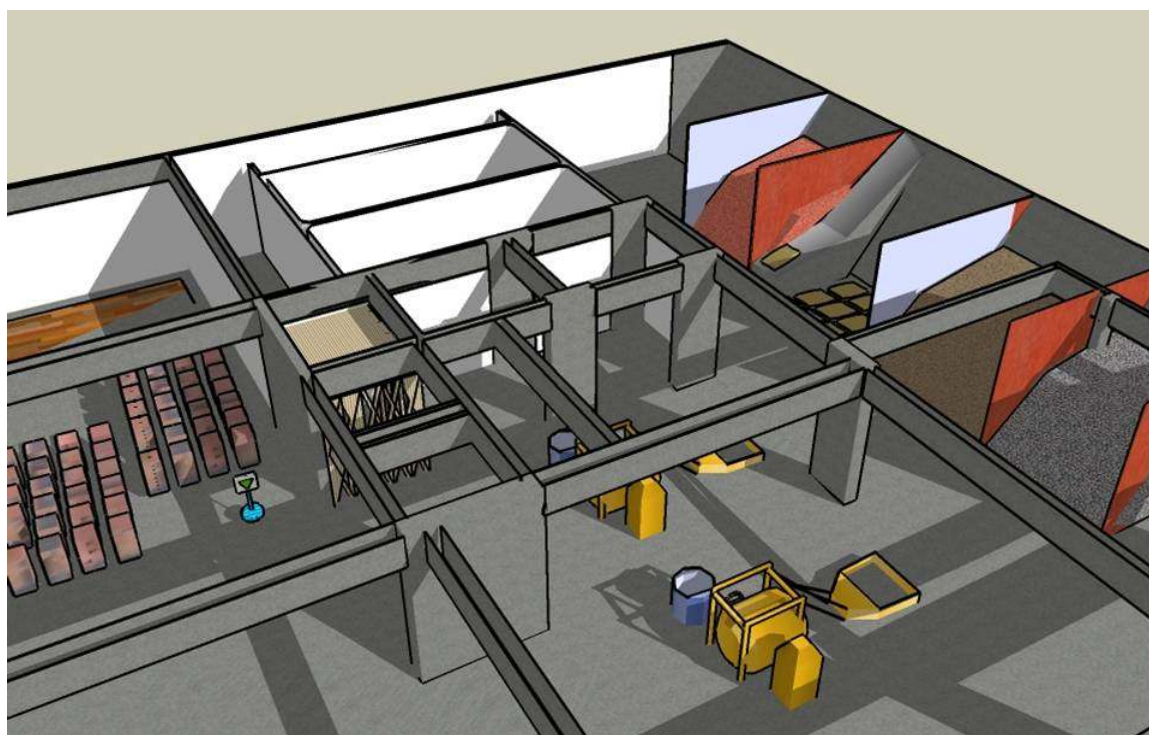
Figura 44 - Projeto de Canteiro do Subsolo – 3D
