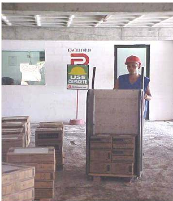
Figura 34 – Transpallets da C. Rolim Engenharia Ltda..
