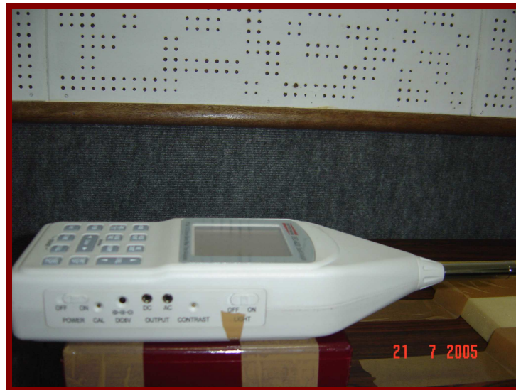
Figura 7 - Decibelímetro com filtro de banda de oitava e terça oitava, modelo DEC-5030, da INSTRUTHERM, digital.
