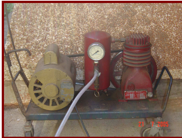
Figura 5 - Suprimento de ar sob compressão por bico de ar-comprimido, marca Douat, modelo CD70D, com pressão de ar de 60 a 80 PS.
