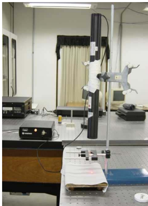
FIGURA 11: Laser HeNe no suporte e lente divergente.
