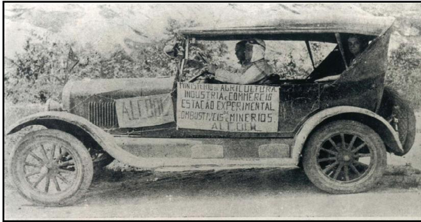
**Figura 4 – Primeiro teste de mistura de álcool e gasolina, em 1925**
