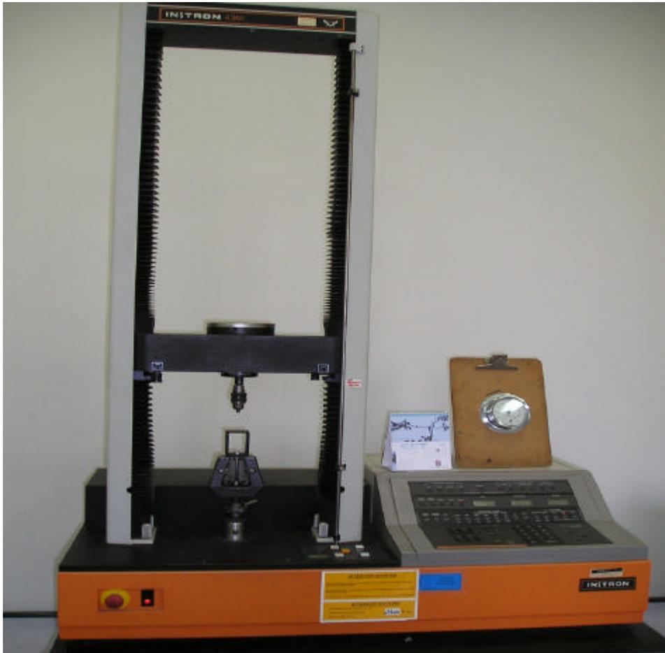
Figura 9 - Máquina de tração Instron 4301.
