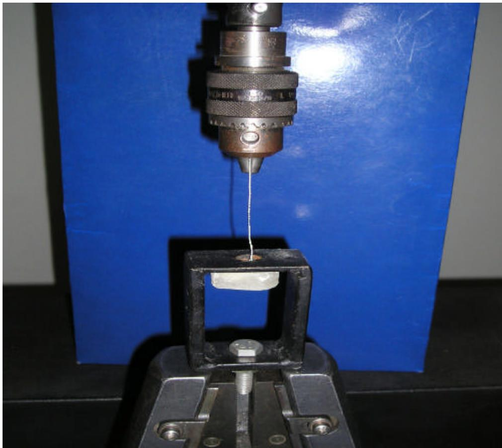
Figura 10 - Máquina Instron 4301 executando a tração de arrancamento do bráquete com velocidade 05 mm/mim.
