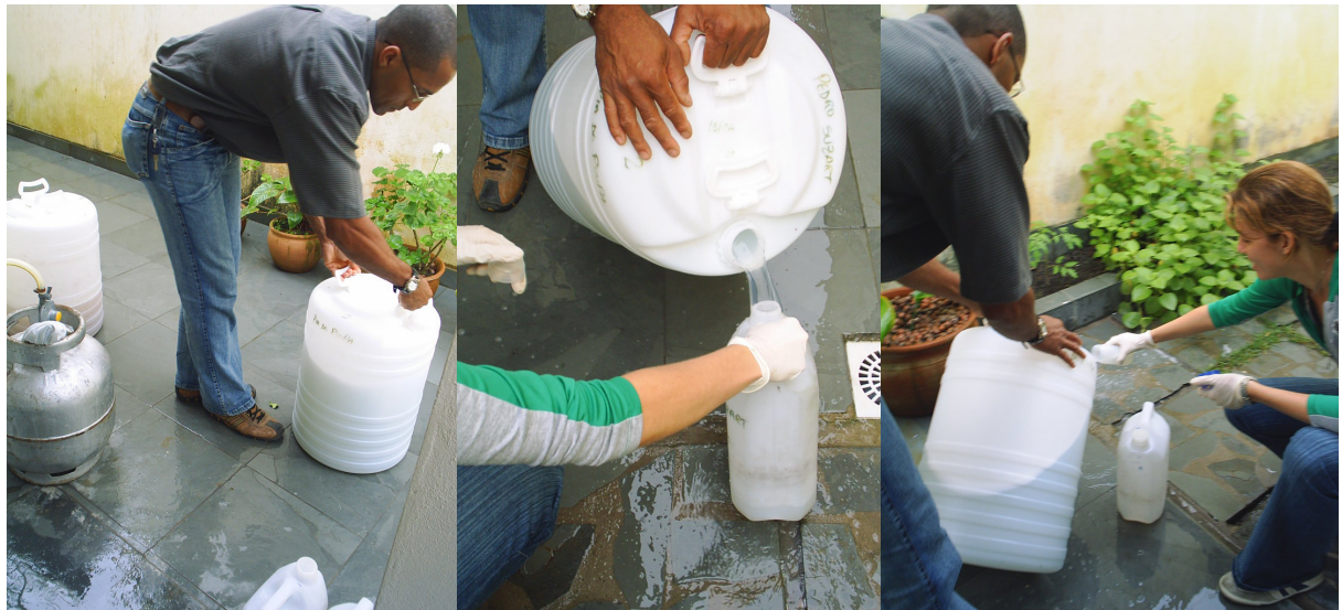
Foto 12: Homogeneização e distribuição dos efluentes em vasos menores.
